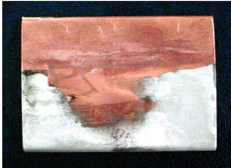
El tercer ensayo se realizó empleando una densidad de corriente de 3A. La Fotografía 8 muestra, un aumento significativo de los polvos de estaño y de la evolución de gases en electrolito con respecto al ensayo 2. La probeta al final del procedimiento se halló en muy mal estado físico; es decir quemada, pulverulenta y rugosa.
