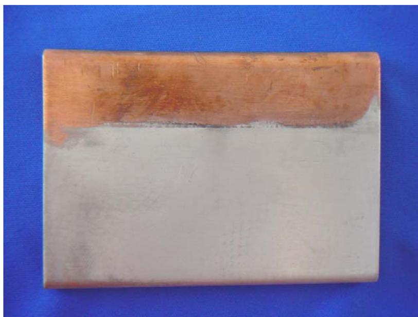
En la segunda platina ensayada a una corriente de 2 amperios, durante un tiempo de 5 minutos, el comportamiento del voltaje fue similar al ensayo anterior, es decir registro una disminución de 0.25V después del tiempo señalado.
