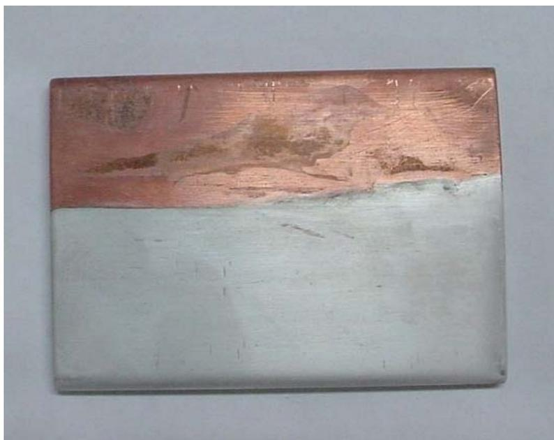
Luego de realizados estos ensayos se optó por trabajar con un rango de densidad corriente entre 0 - 4 A/dm<sup>2</sup> porque el deposito presentó las mejores características al trabajar en la celda Hull para una corriente de 1 Amperio.
