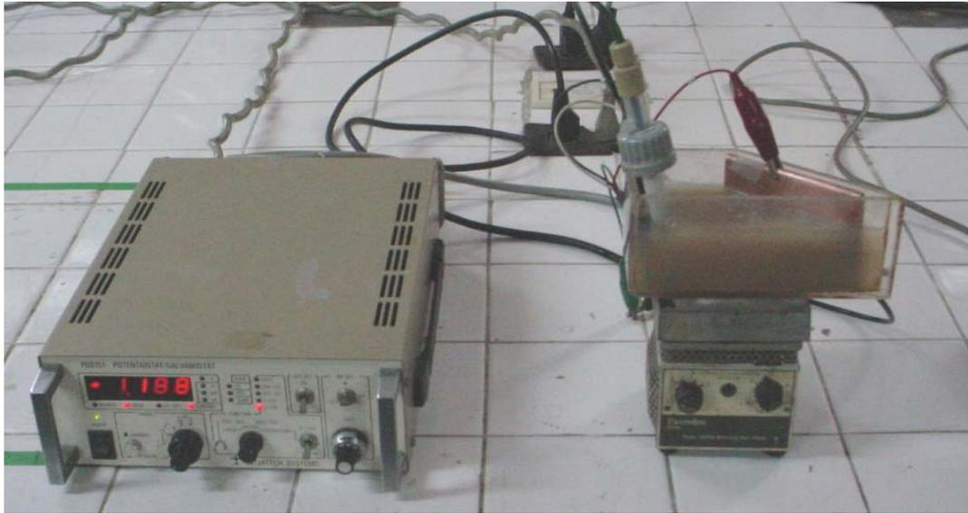
La caracterización del electrolito se hizo en la celda Hull (Fotografía 3), esencial para electrolitos que buscan en primera instancia determinar los rangos de densidad de corriente en el cual el depósito posee una buena apariencia. En esta celda se produce un depósito electrolítico con una densidad de corriente que varía en una forma continua de un extremo a otro del cátodo. En resumen, con un solo ensayo se llega a sustituir toda una serie de experimentos a diferentes densidades de corriente.
