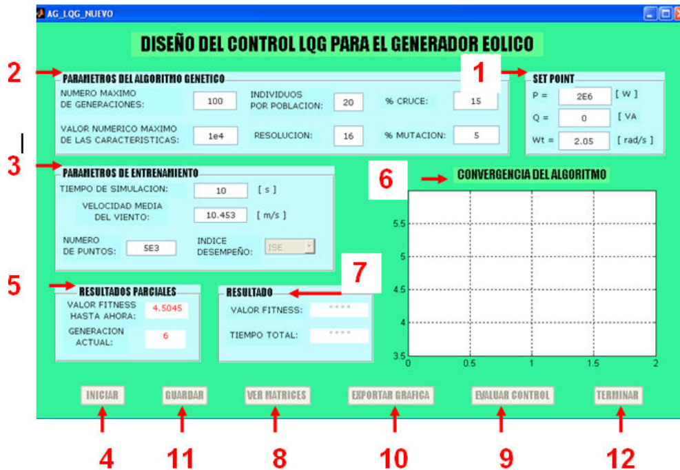
Figura 45. Parámetros del algoritmo genético en la herramienta gráfica (Fuente: Autores.)
