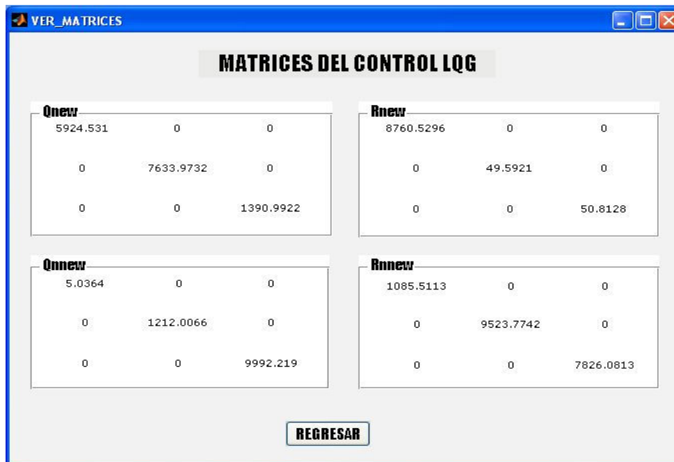
Figura 23. Gráfica de las matrices Q, R, Qn y Rn diseñadas en la herramienta gráfica AGWIN (Fuente: Autores)
