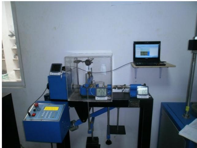
Fotografía del equipo de corte directo utilizado usado. Se utilizó el método de control de deformaciones-CD-Consolidado Drenado
