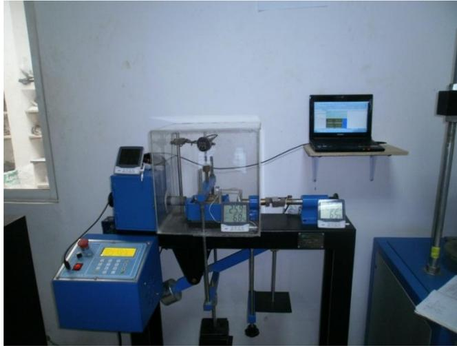
Fotografía del equipo usado. Se utilizó el método de control de deformaciones-CD-Consolidado Drenado
