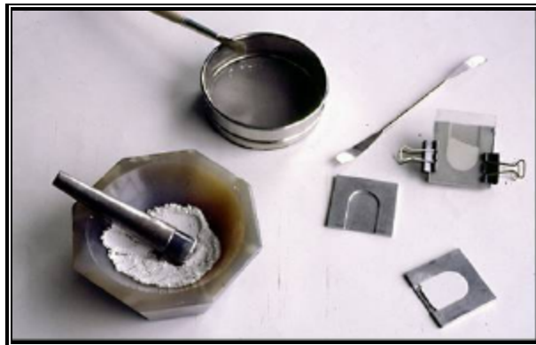
Figura 18. Montaje de la muestra por llenado lateral
