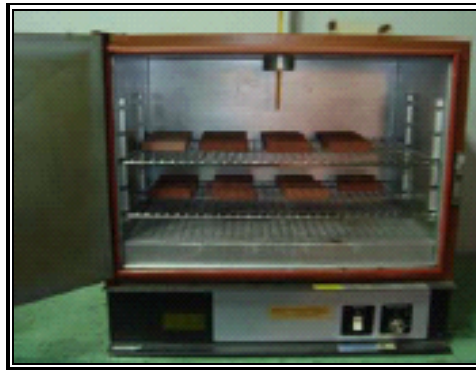
Figura 33. Estufa marca DESPATCHT, modelo LEB 1-28, usada en la etapa de secado
