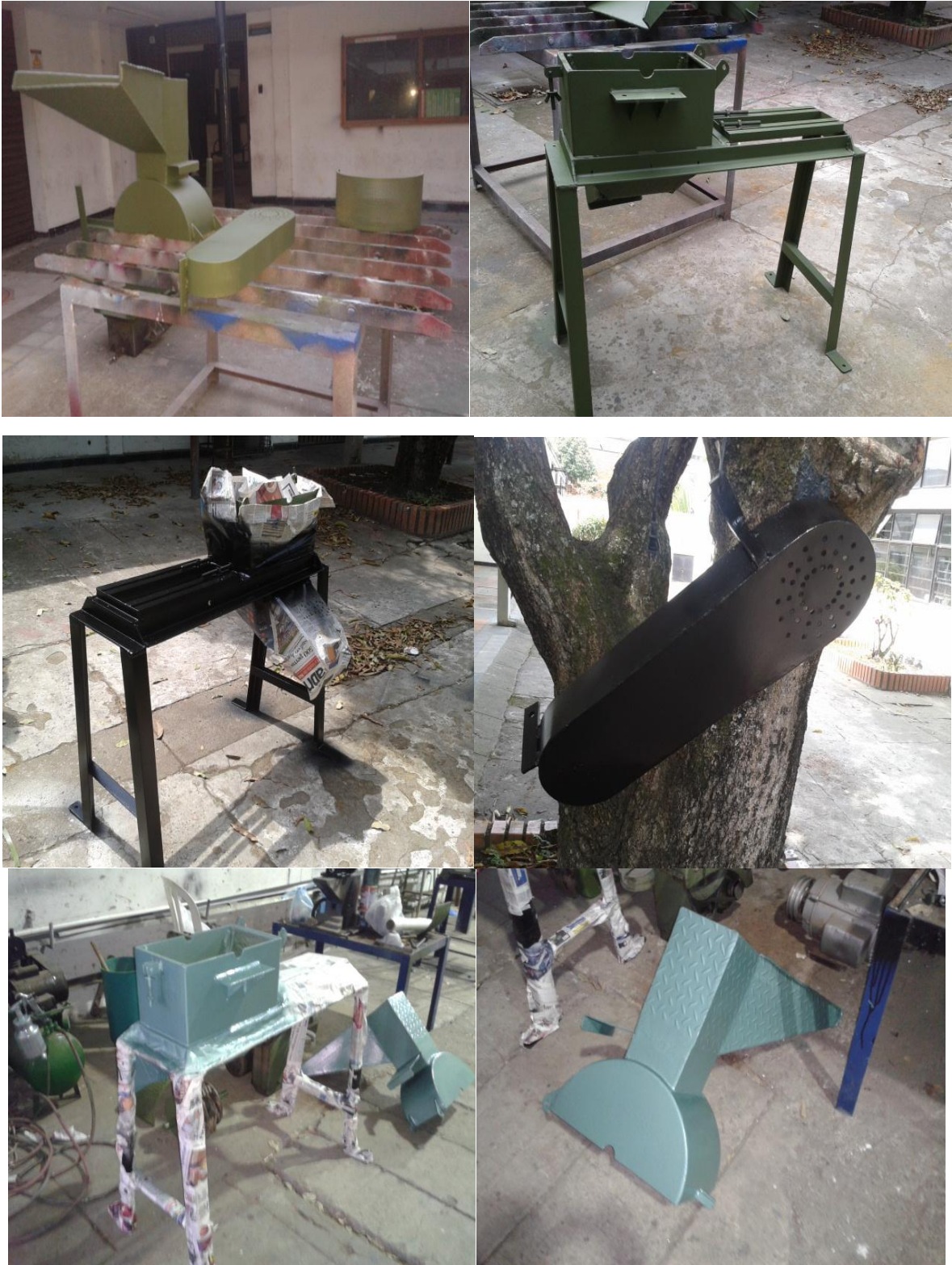
Figura 61. Proceso De Pintura Y Ensamblaje De La Maquina
