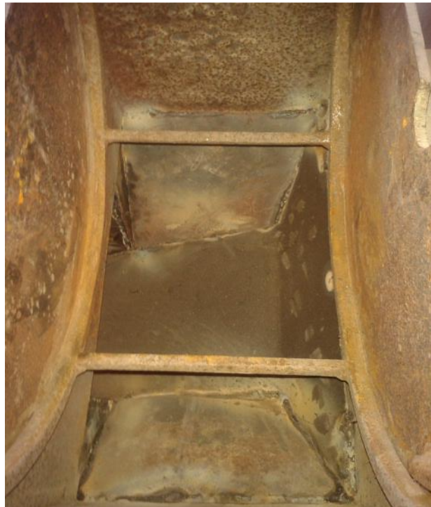
Figura 55. Porta criba soldado a las paredes del molino
