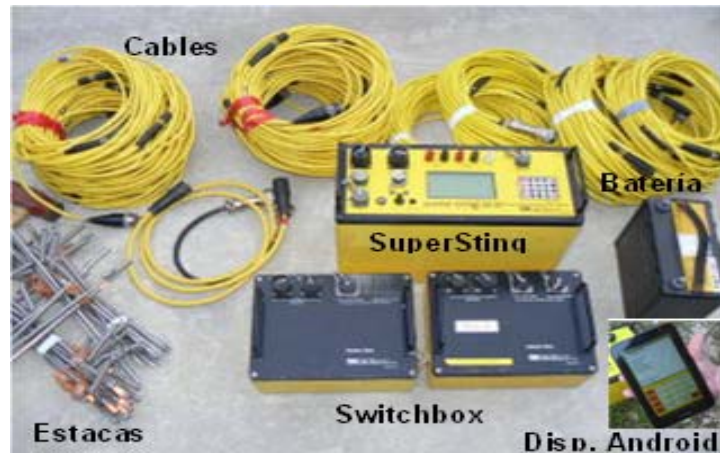
Figura 30. Vista del equipo SuperSting R/8 usado en la exploración geotécnica
