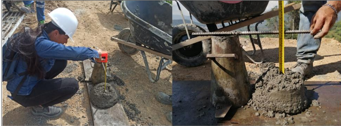
Figura 29. Medición del asentamiento.
