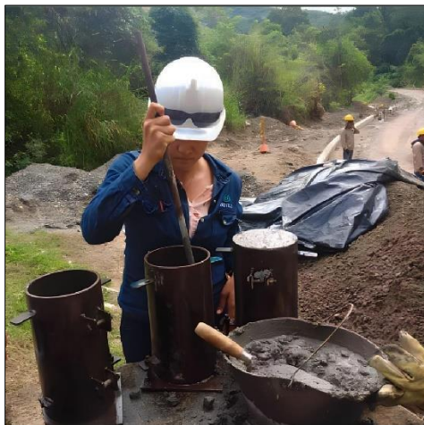
Figura 28. Realización de las probetas de concreto.
