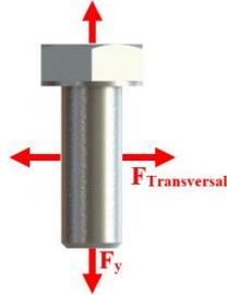
**Cálculos de Esfuerzos en la Junta*****Resistencia al Corte de la Junta***
