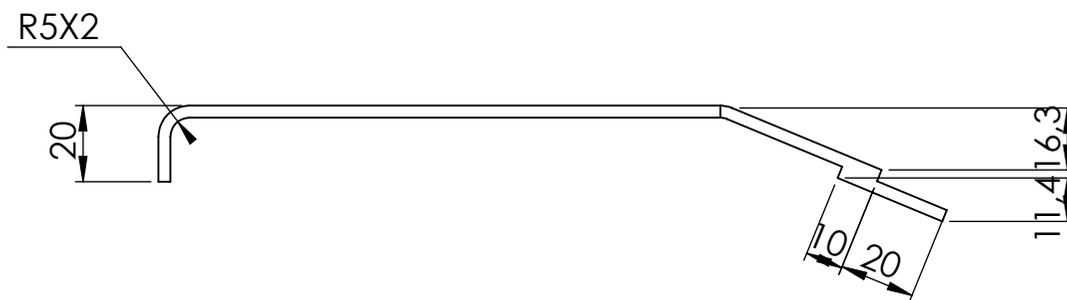
LÁMINA DE 1/8" DE ESPESOR
