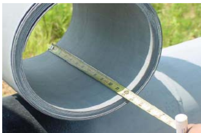
Ilustración 30 Medición del Weldwrap
