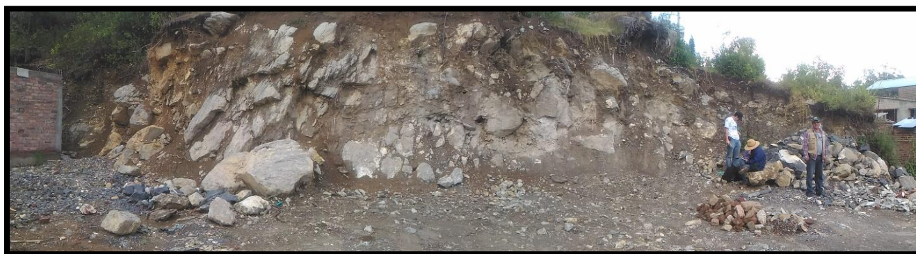
Ilustración 53: Fotografía panorámica del Afloramiento 2, la roca se presenta de forma masiva y muy diaclasada, por lo tanto no se puede diferenciar estratificación.
