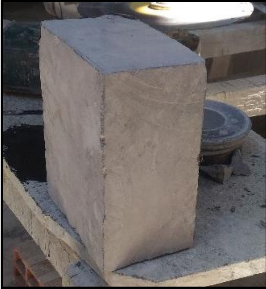
Ilustración 82: Bloque de muestra cortado para analizar.
