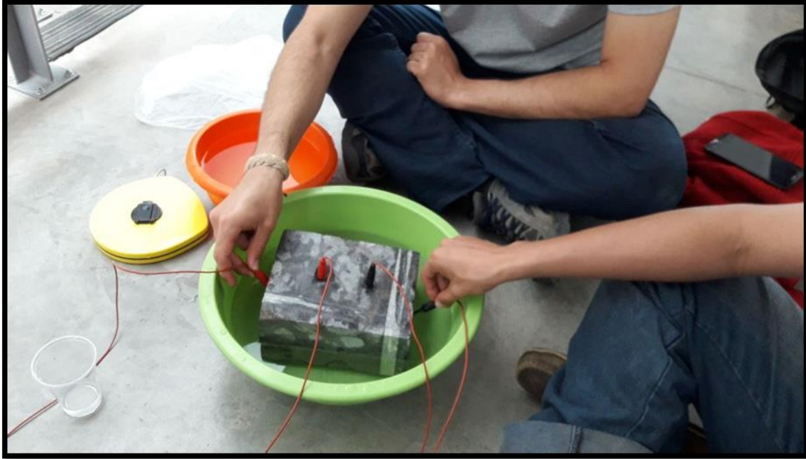
Ilustración 86: Prueba de resistividad en roca caliza en condición saturada.
