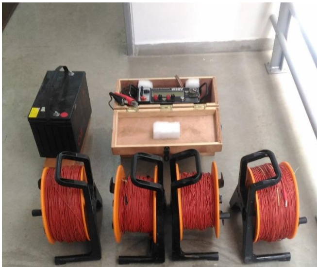
Ilustración 40: Equipo de registro utilizado para La adquisición de los sondeos eléctricos verticales se realizó con el instrumento ABEM Terrameter SAS 1000 desarrollado por la compañía ABEM Instrument AB.
