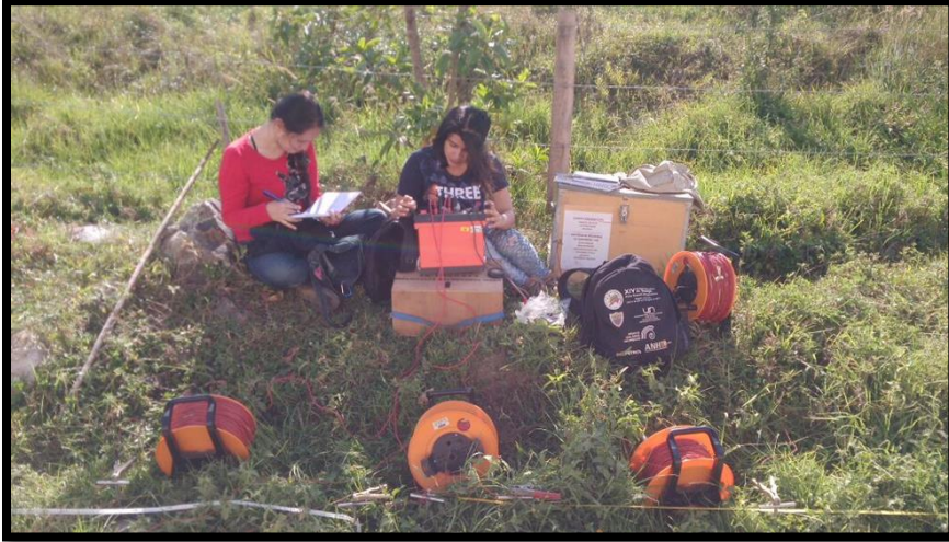
Ilustración 41: Realización del montaje en campo del equipo de registro para los sevs.
