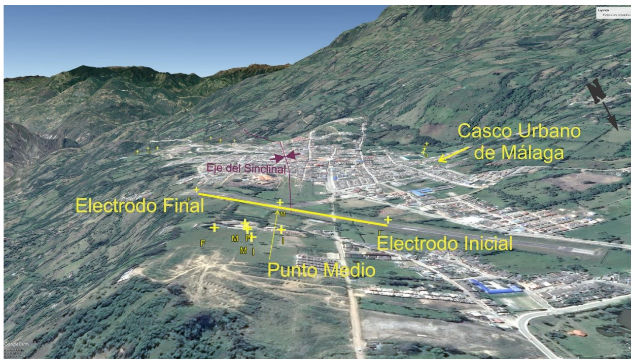
Ilustración 72: Ubicación de la tomografía eléctrica resistiva Aeropuerto en el municipio de Málaga, Santander. El eje del sinclinal se obtuvo a partir de la Geología de la Plancha 136 Málaga del Servicio Geológico Colombiano 1984. La imagen de fondo se obtuvo de Google Earth.
