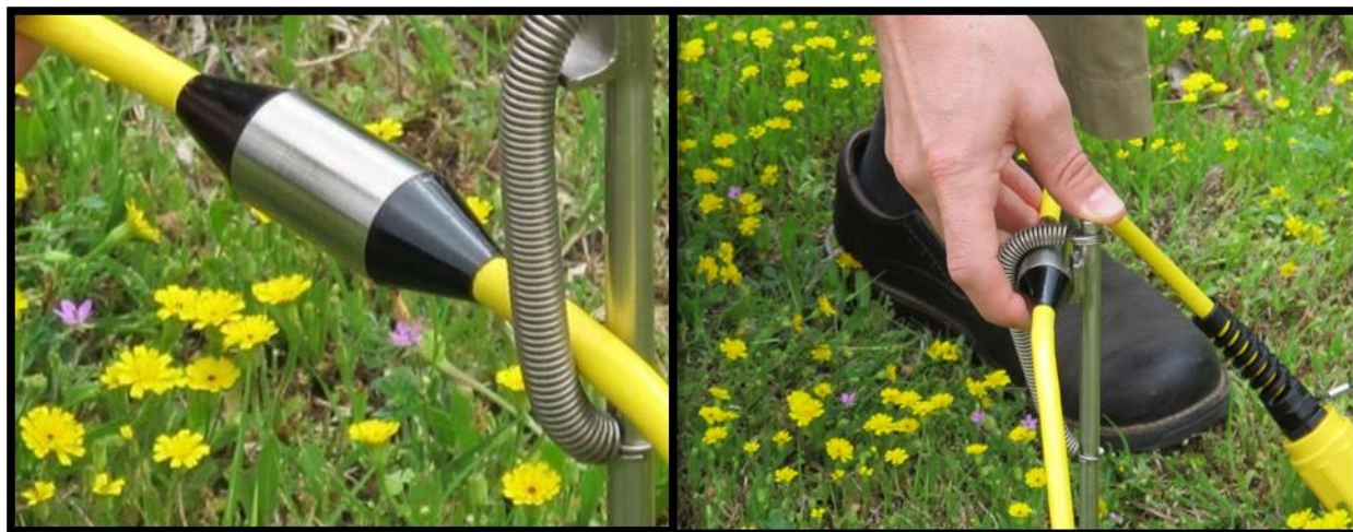
Ilustración 39: Electrodo pasivos tipo “Take-outs”. Estacas de acero inoxidable diseñadas para sostener los electrodo. Tomado de Página web de la Advanced Geosciences, Inc.
