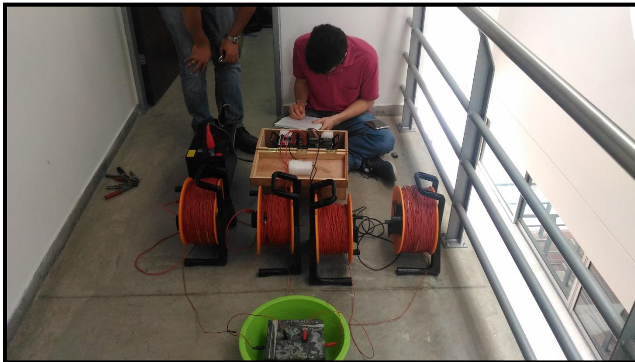
Ilustración 85: Prueba de resistividad en roca caliza en condiciones húmedas.
