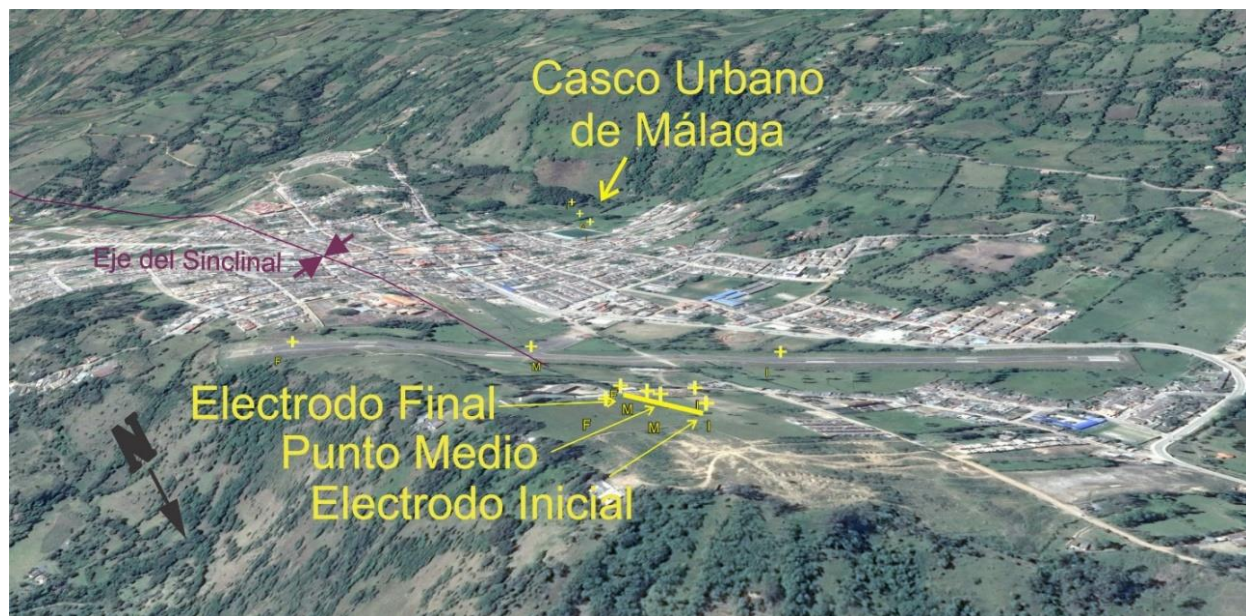
Ilustración 76: Ubicación de la tomografía eléctrica resistiva UIS 2 en el municipio de Málaga, Santander. El eje del sinclinal se obtuvo a partir de la Geología de la Plancha 136 Málaga del Servicio Geológico Colombiano 1984. La imagen de fondo se obtuvo de Google Earth.
