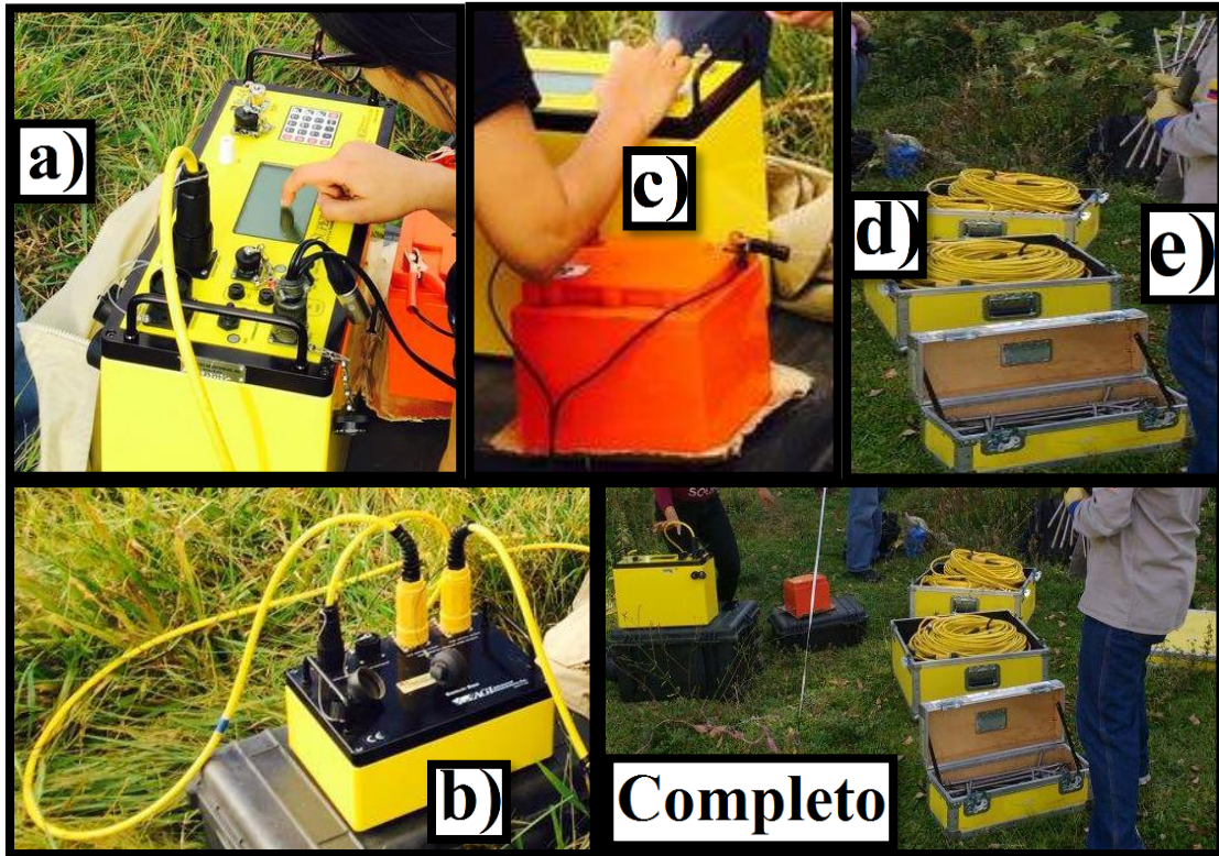
Ilustración 37: Componentes del equipo utilizado (tomógrafo). Fotografías tomadas en campo
