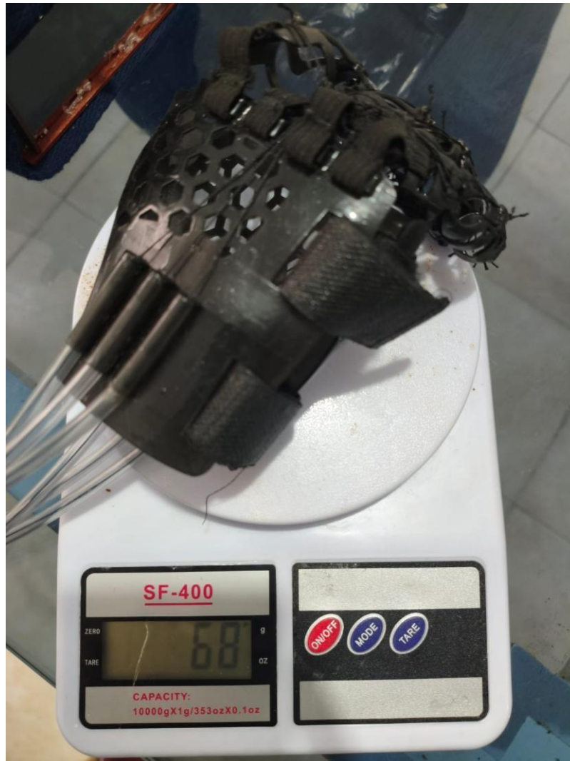
Figura 44. Peso de la estructura en la mano.
