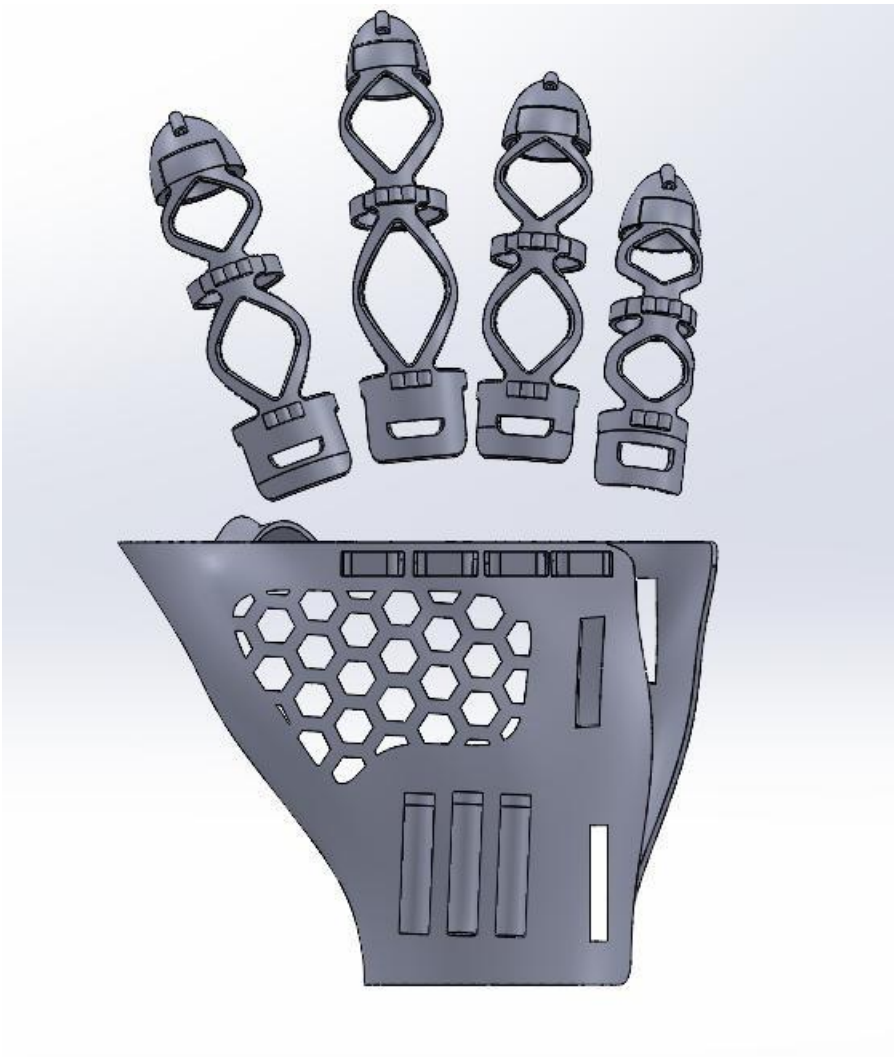
Figura 41. Vista trasera de estructura palma y dedos.
