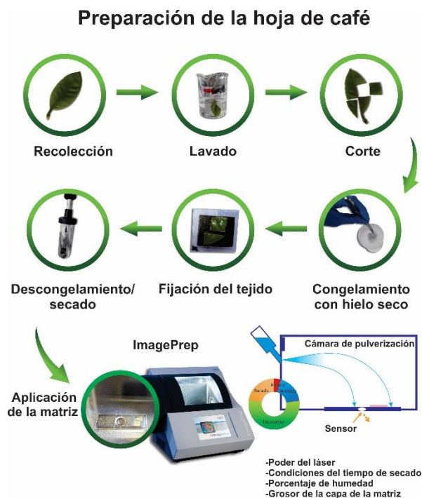
Figura 17. Protocolo de preparación del tejido para MALDI-IMS
