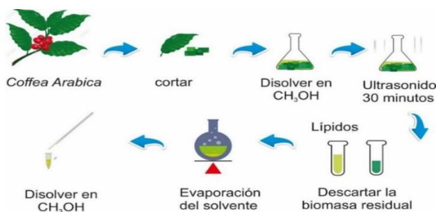
Figura 15. Protocolo para la extracción de lípidos utilizando metanol
