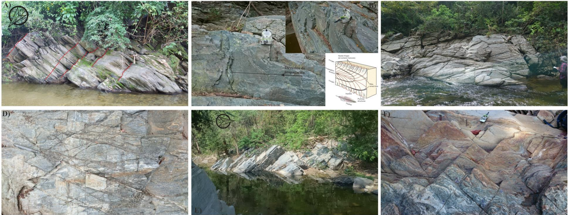
Figura 57. Patrones de diaclasamiento a lo largo de la quebrada La Aguja. A, D, E y F patrones de diaclasamiento sistemático. A en QA_E006, D en QA_E011, E en QA_E051, F en QA_E086. B: Patrón de diaclasamiento en pluma. QA_E021 C: Patrón de diaclasamiento no sistemático, caracterizado por un espaciado no uniforme y con fracturas que presentan curvatura. QA_E024.
