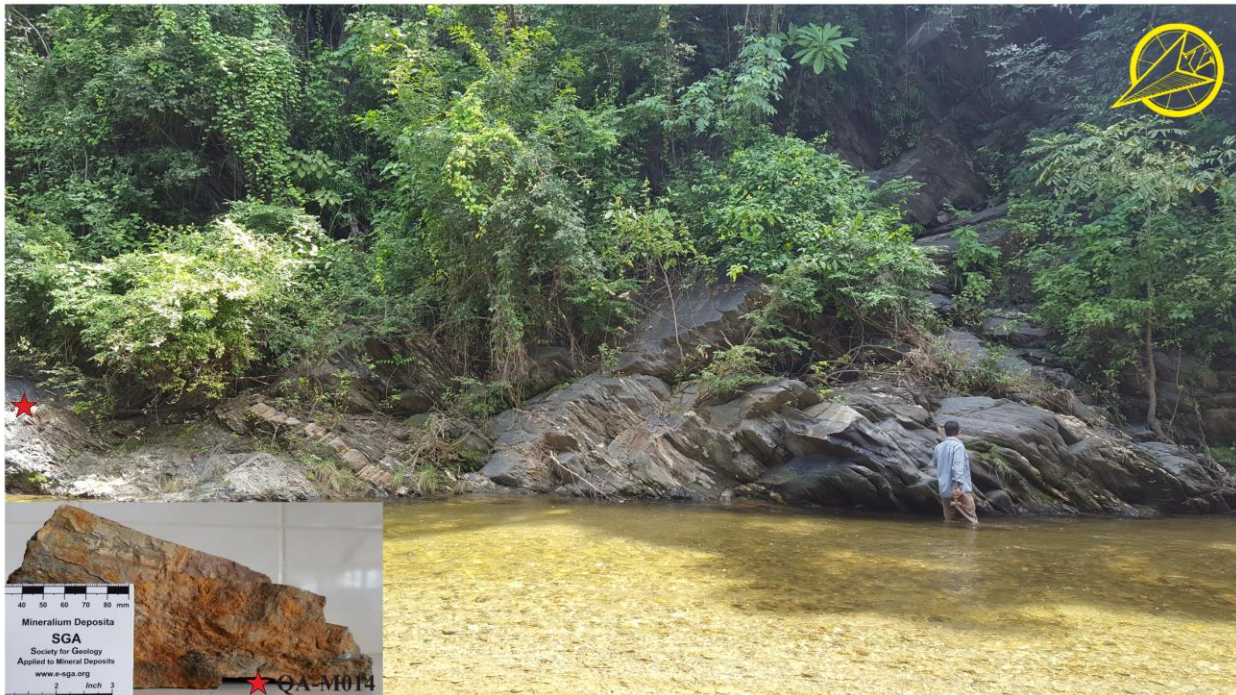
Figura 19. Esquistos cuarzo-micáceos. Afloramiento de la estación QA-E007 (N: 1703504; E: 990087; Z: 27) con muestra de mano QA-M014.
