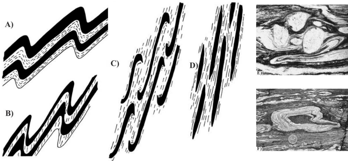
Figura 61. Pliegues en zonas de cizalla. A: Plegamiento flexural de la secuencia de capas rígidas (negro) y suaves (blancas). B: Plegado estrecho y comienzo del desarrollo del clivaje. C: Atenuación y rotura de los limbos del pliegue. D: Aplanamiento de secuencia y creación de pseudoestratigrafía. E: Pliegue interfolial asimétrico en granito milonítico. El sentido destal del cizallamiento indicado por el pliegue es soportado por los flancos asimétricos del porfiroclasto redondo y superpuesto de feldespatos. F: Pliegue en forma de ojo, reflejando un eje de pliegue curvado, dentro del neis bandeado. Tomado y editado de Davis et al. (2012).
