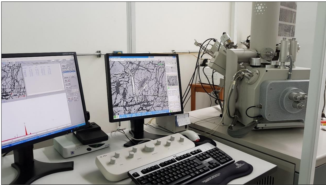
Figura 3. Microscópio electrónico de barrido FEI Quanta 650 FEG ambiental (ESEM).
