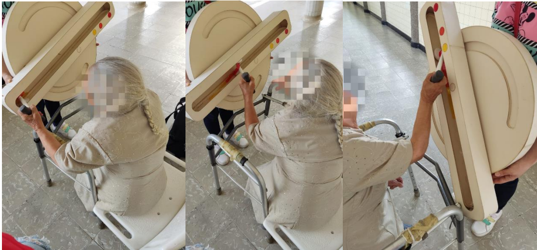
Figura 6. Evidencias fotográficas de la primera prueba con el modelo de papel. De izquierda a derecha. Modificación de alcance y ángulo del brazo del modelo.
