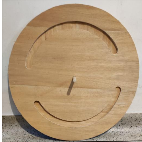
Figura 12. Base redonda con los ajustes de ángulos para el brazo.
