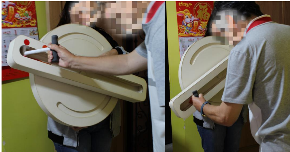
Figura 8. Evidencias durante la tercera prueba con el modelo de papel. De izquierda a derecha. Modificación de alcance y ángulo del brazo del modelo.
