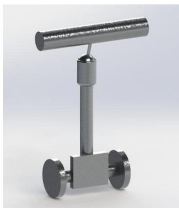
Figura 15. Mango con la superficie de reflejo para el láser.
