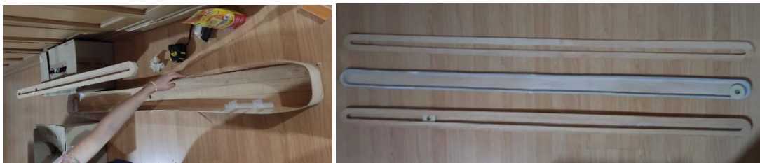
Figura 13. Construcción del brazo y de los carriles internos.
