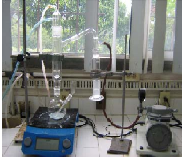
Montaje para realizar la destilación de cianuros
