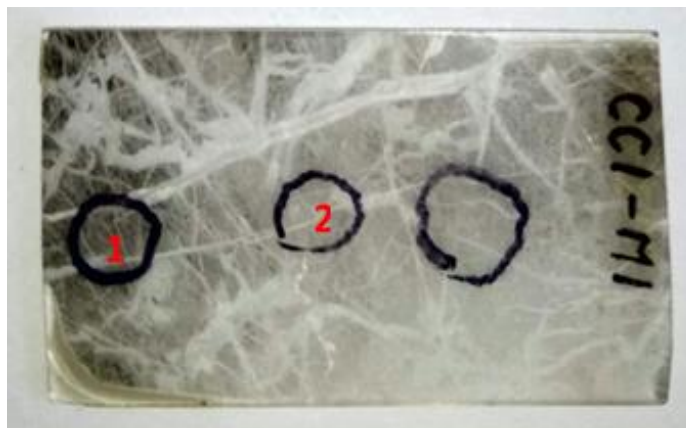
Figura 48. Fotografía de las zonas analizadas por medio del SEM para la sección delgada CC1-M1.
