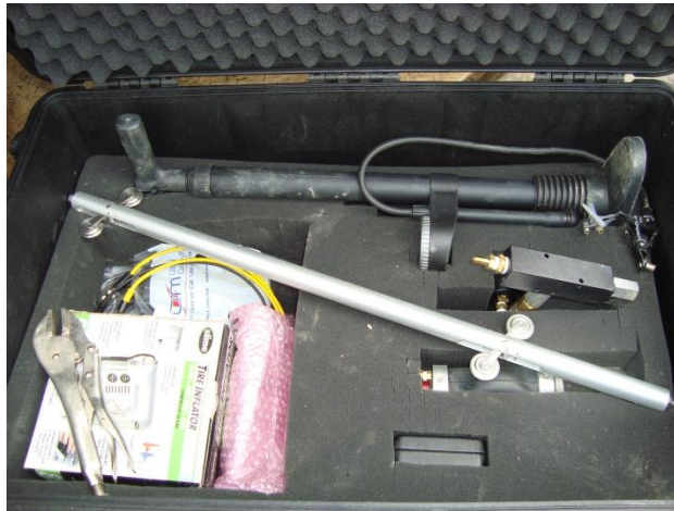
Foto 3 Geófono, el tubo guía, la bomba de aire entre otros
