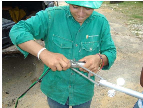
Foto 6 Conectando el geófono al tubo guía
