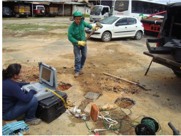
Foto 9 Generando Ondas P mediante golpes en la platina de acero
