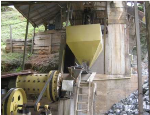
Fotografía 6. Ejemplo de un molino alimentado con banda transportadora
