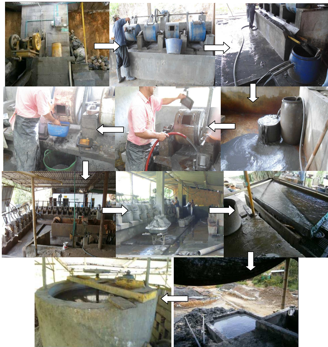
Figura 7. Fotografías del consecutivo en el proceso de beneficio de oro en minería de veta con mercurio
