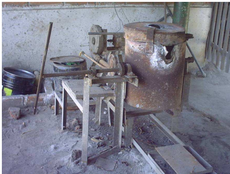
Fotografía 12. Ejemplo de un pequeño horno basculante a gas propano
