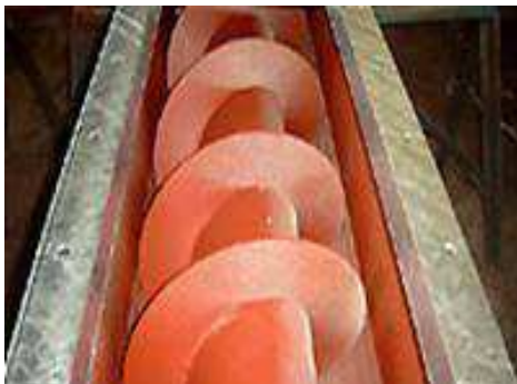
Fotografía 7. Ejemplo de clasificador de tornillo o Atkins
