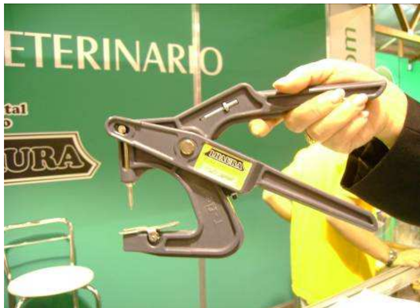
Foto 4. Pinza aplicadora de orejeras o caravanas
