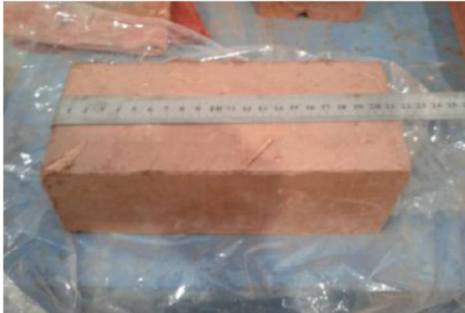
Figura 7. Medida de la longitud de ladrillo
