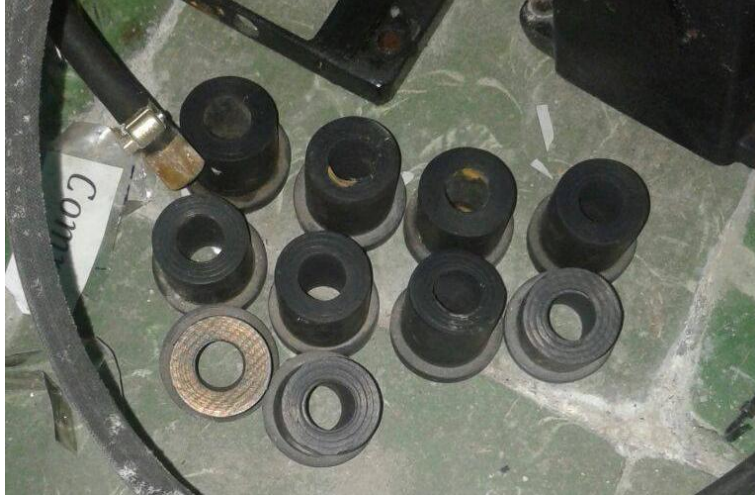
Figura 55. Soportes de amortiguación utilizados en el motor eléctrico y compresores
