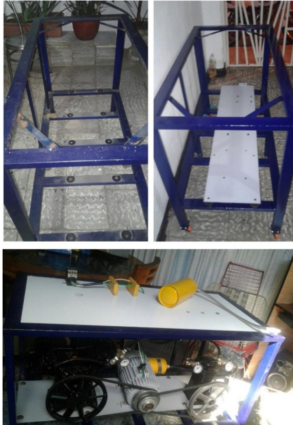
Figura 29. Estructura del banco
