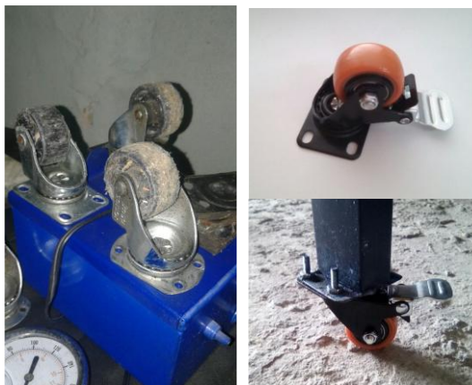
Figura 38. Ruedas dañadas y de seguridad de la estructura
