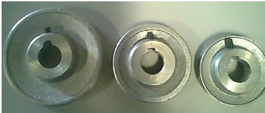
Figura 49. Poleas acopladas al eje y a los compresores
