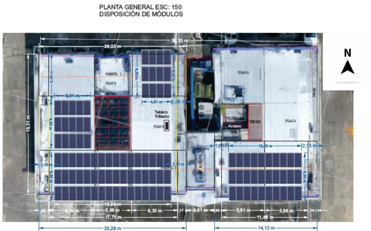
Figura 6. Disposición paneles solares en la placa del edificio El Parnaso de ESSA
