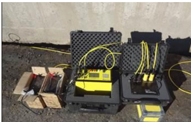
Figura 10. Equipo SuperSting R8 IP para realizar Tomografías Eléctricas 2-D, 3D Y 4D
