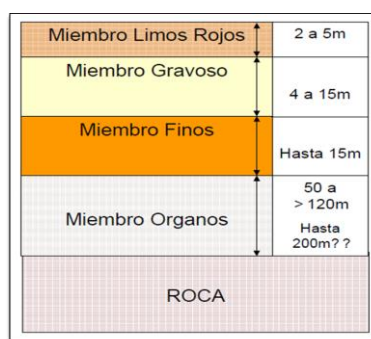
Figura 5. Perfil típico y espesores promedio de la Formación Bucaramanga. Tomado de: INGEOMINAS, (2001). Zonificación sismogeotécnica indicativa del área metropolitana de Bucaramanga, Colombia
