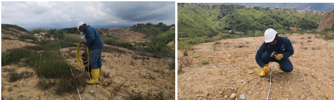
Figura 13. Extendido e instalación de electrodos y multicable para la Tomografía Eléctrica 2D
