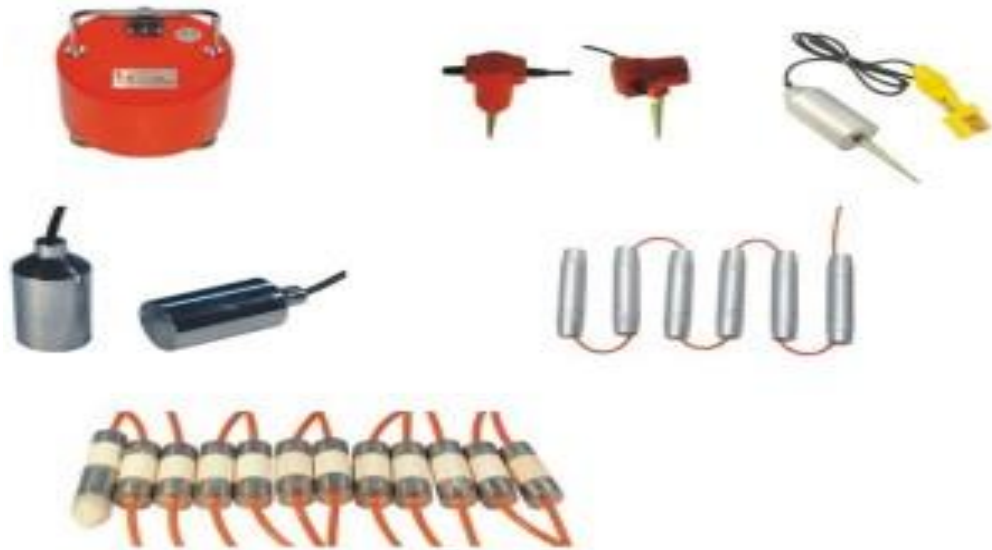
Figura 2 Geófono o Sensor Receptor de Señal
