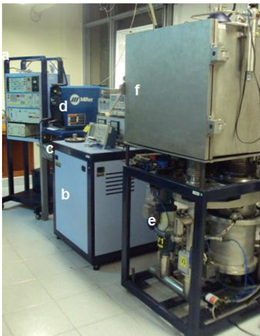
Figura 5. Reactor MOSMET a) panel de control. b) Fuente de alto voltaje, c) Panel de encendido descarga de arco, d) Fuente para el arco eléctrico, e) Sistema de Vacío, f) Cámara de descargas. [25]
