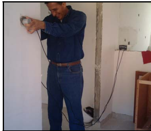
b. Prueba de ultrasonido
