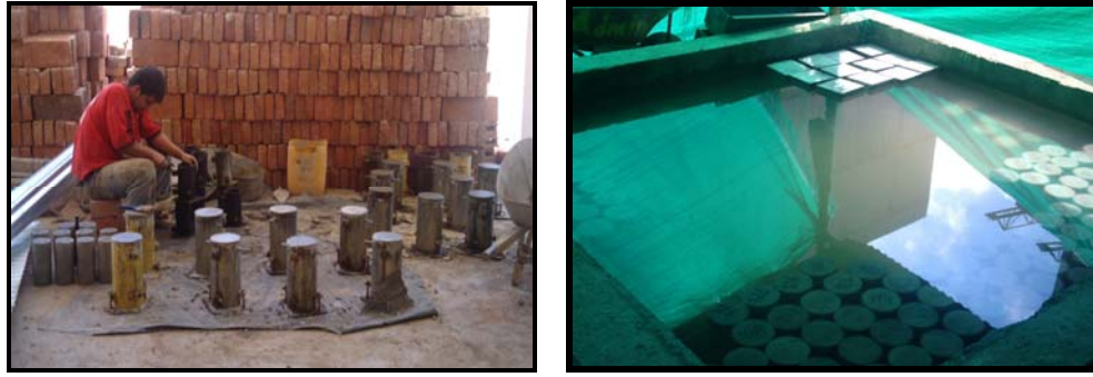
Figura No. 4. Elaboración y curado de muestras de concreto
