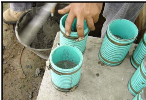
Figura N.º 6. Probetas para cilindros de mortero
