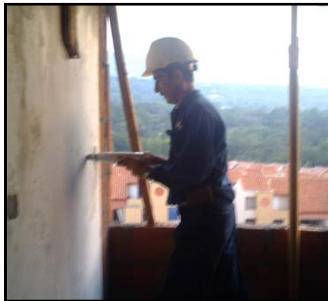
a. Prueba con el esclerómetro
