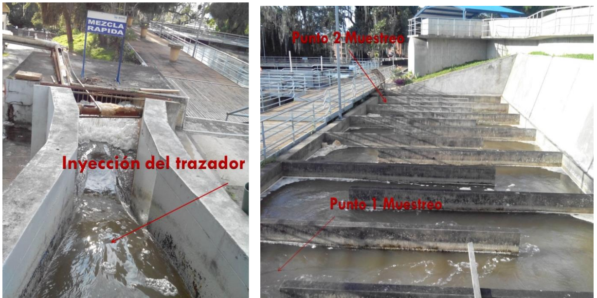
Figura 5. Fotografías: Punto de inyección y puntos de muestreo del trazador.
