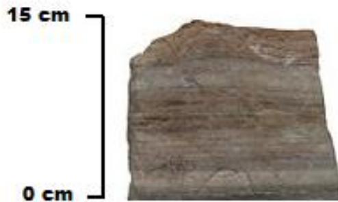
Figura 6. Muestra de roca metamórfica con un corte en la cual el eje axial es perpendicular a los sedimentos. Fuente [3]
