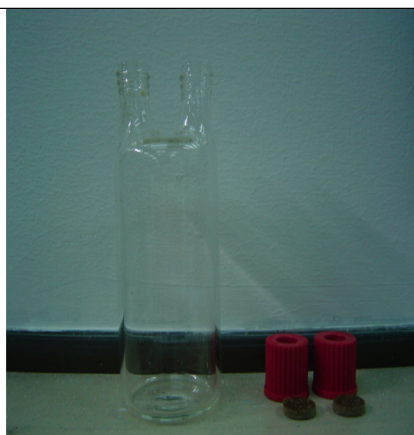
Figura B. 2 Celda de equilibrio Vista frontal
