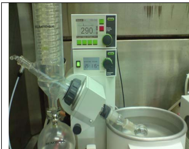
Figura B. 3 Rotaevaporador Büchi R-215
