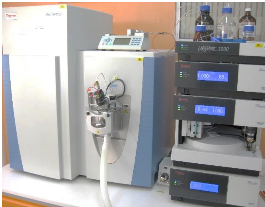
Figura 10. Cromatógrafo líquido de ultra alta eficiencia (UHPLC) acoplado a un detector de masas ( Orbitrap ), por medio de una interfaz HESI. Foto tomada por Dra. Elena Stashenko. Lugar: Laboratorio Makarov, CENIVAM-UIS, Bucaramanga.
