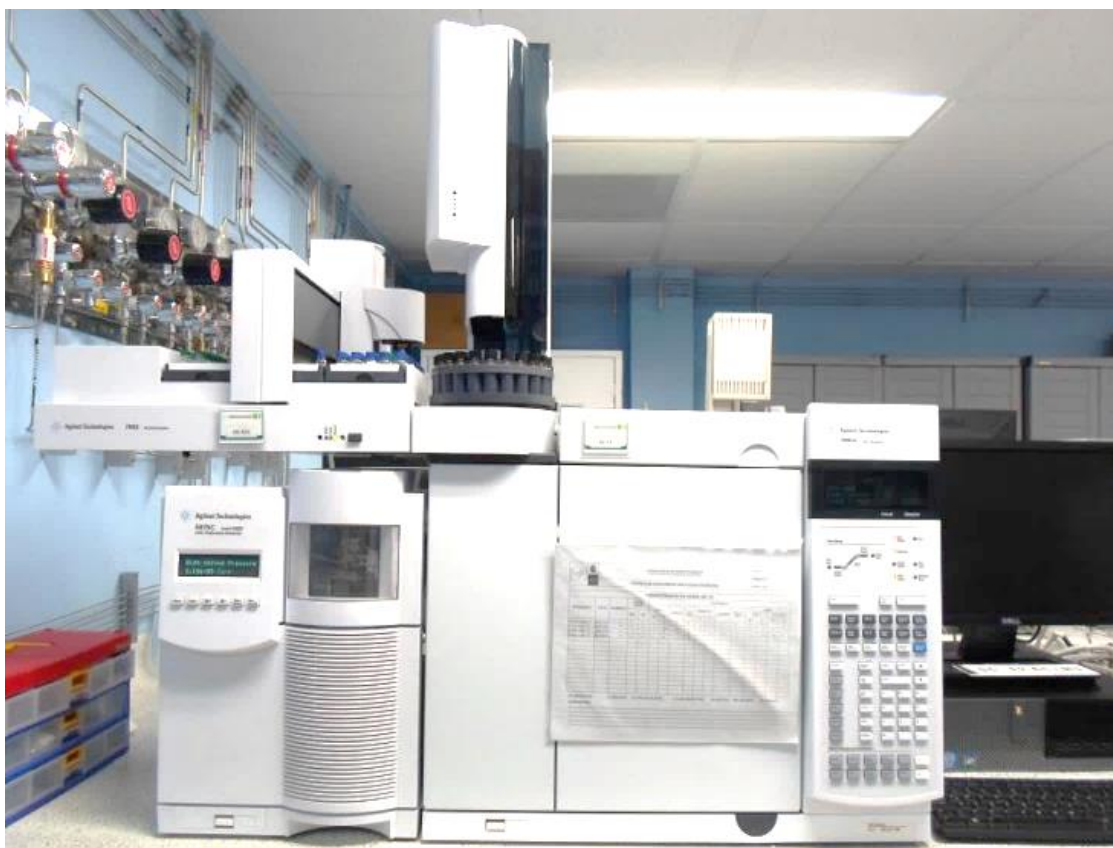
Figura 11. Cromatógrafo de AT 6890 Plus acoplado a un detector selectivo de masas AT 5973 Network . Fuente: Julián Lozano, Laboratorio de Instrumentación Analítica CROM-MASS. UIS, Bucaramanga, 9 de julio de 2017.
