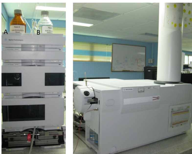
Figura 9. Cromatógrafo líquido AT 1200 Series con analizador de tiempo de vuelo AT TOF-MS 6210 Series. Laboratorio: Análisis instrumental, CROM-MASS. Fuente: Fausto Prada, 17 de diciembre de 2016.
