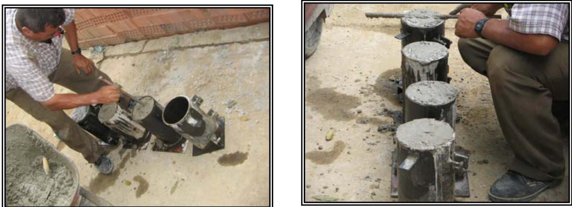
Figura 10. Ejecución de probetas en obra, para ensayos, febrero de 2006.
