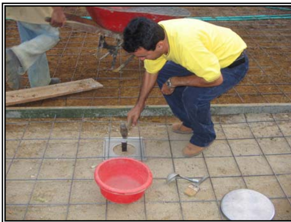
Figura 28. Ensayo de densidad en terreno, Febrero de 2006.
