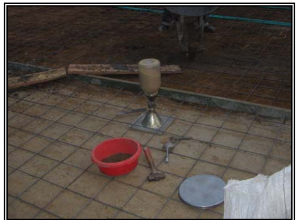
Figura 28. Ensayo de densidad en terreno, Febrero de 2006.
