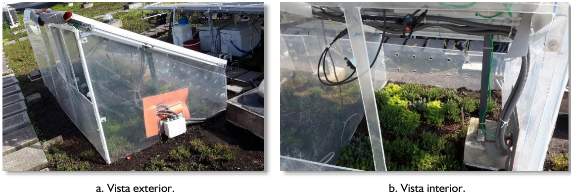
Figura 27. Estructura de acrílico para la variación de la velocidad del aire.
