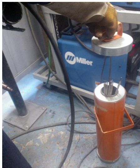
c) Recipiente para mantener electrodos sin humedad.
