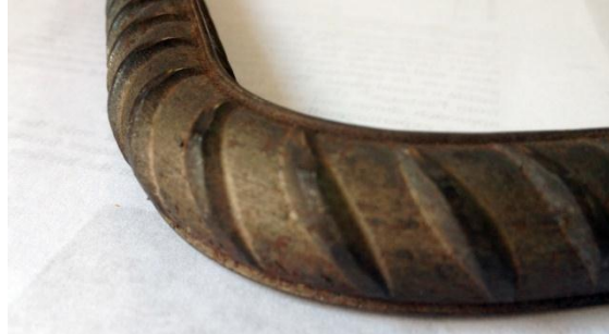
Figura 15. Probeta ensayada para doblez, superficie radio exterior. Sin presencia de discontinuidades.
