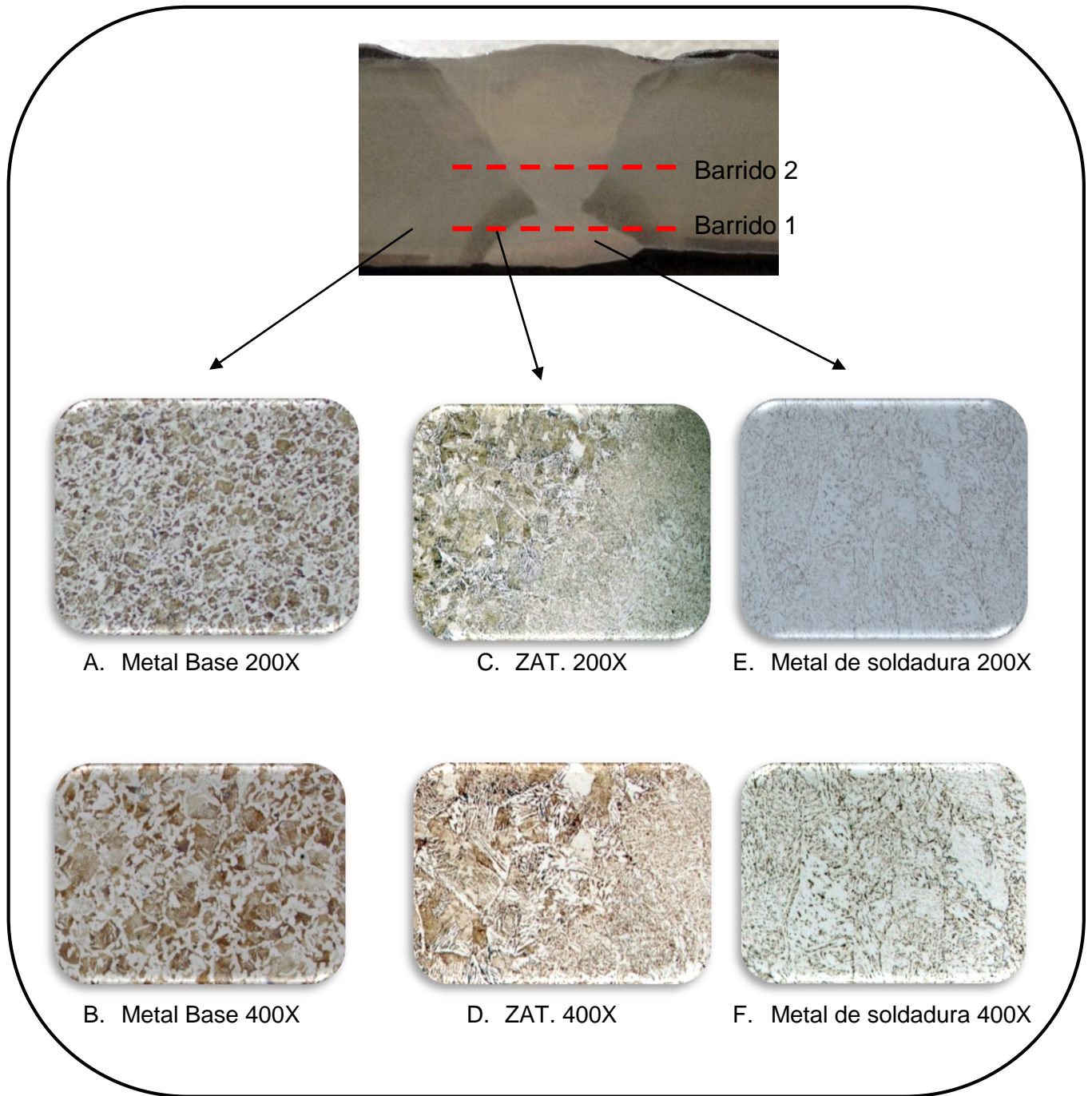
Figura 23. Metalografía junta soldada tope directo bisel en V.
