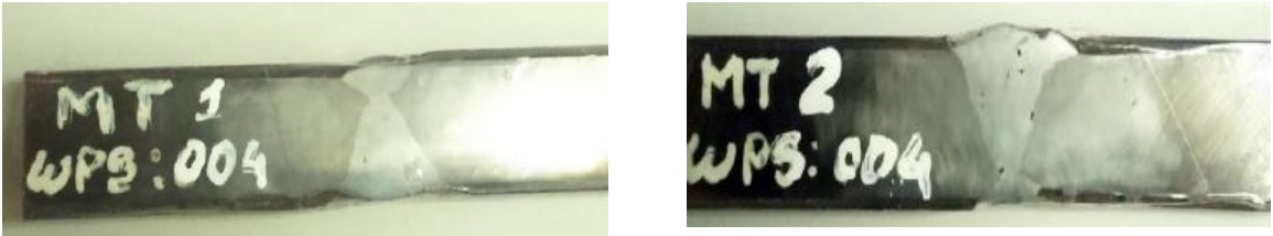
Figura 19. Ensayo de macroataque a junta de tope directo, la que presentó porosidad aislada fue la probeta MT2.WPS 004.
