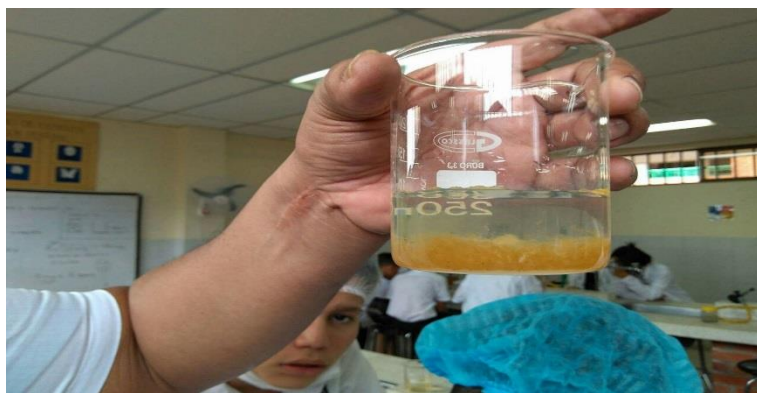
Fotografía 2. Proceso de floculación
