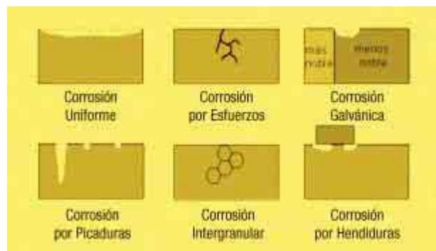
Figura 1: Formas de corrosión
