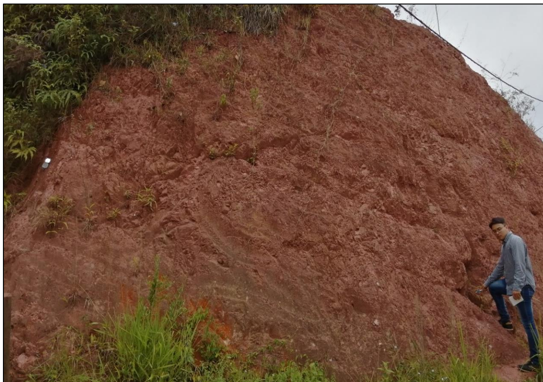
Figura 39. Roca vs Suelo ubicada en el costado W y acceso al vivero en vía al Cerro la Cantera. Se presenta depósito coluvial antiguo (Qca) y Formación Girón (Jg) fallada a la derecha. Toma del 13 de junio de 2019.
