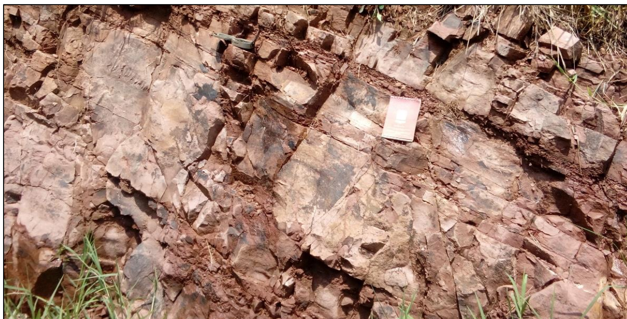
Figura 45. Sistema ortogonal de diaclasas en el que se muestra la orientación de la estratificación (buzante hacia la derecha), con ángulos perpendiculares entre sí.
