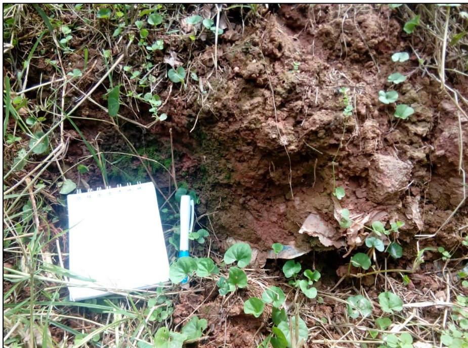
Figura 37. Depósitos de llenos antrópicos (Qllen), con escombros y restos de plásticos envueltos en matriz areno-gravosa. Ubicación: frente de la manzana O del Barrio Bariloche II.
