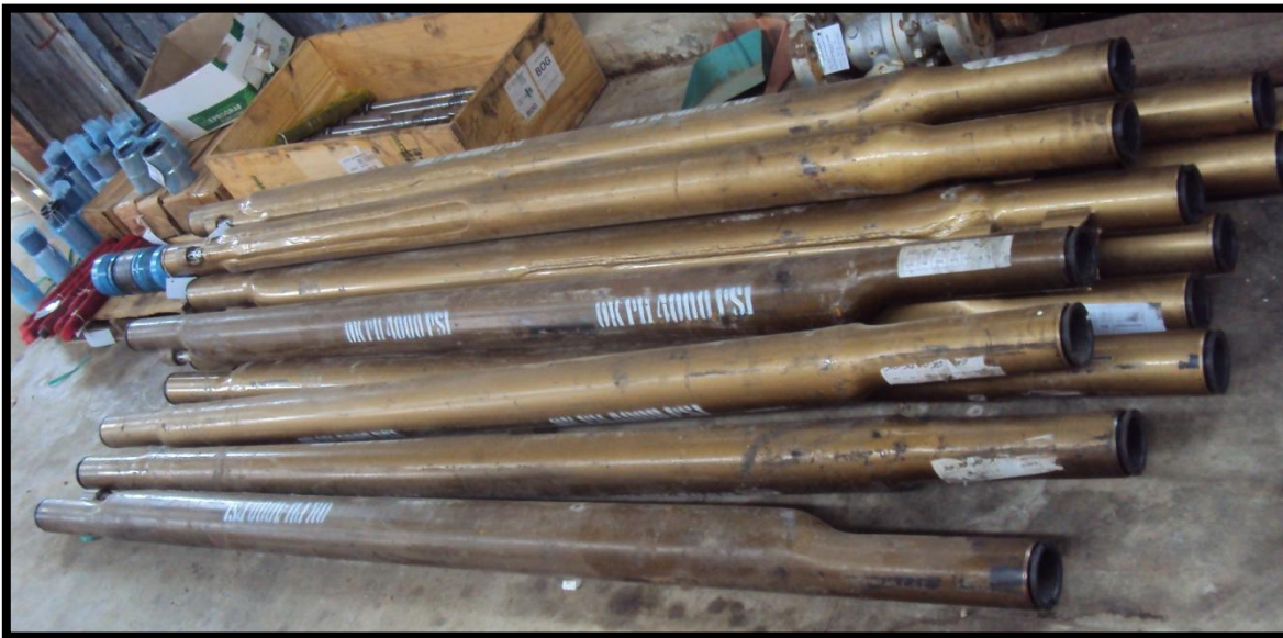
Figura 18. Mandril de Inyección tipo M Orificio 1-1/2
