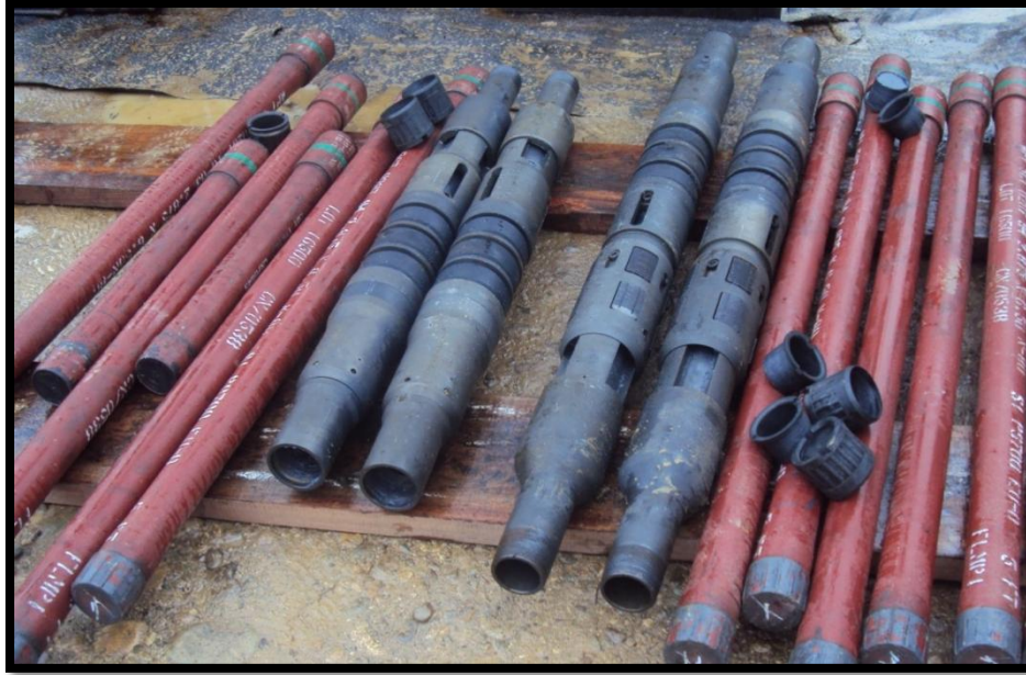
Figura 16. PKR TANDEM “C-3” (Izquierda) y PKR “PCS-1” (Derecha)
