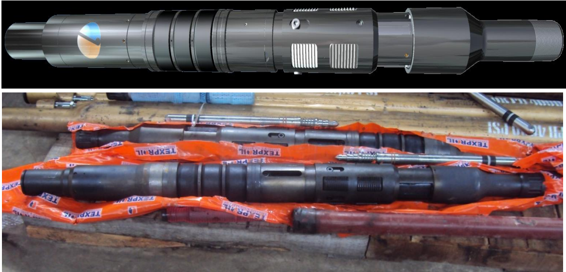
Figura 14. Empaque recuperable Hidráulico "PCS-1" (Texproil)
