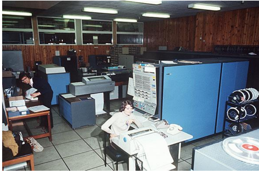
Figura 14. Modelo IBM 360/50 utilizado por CECOLDO mediante los servicios del SENCO-DANE
