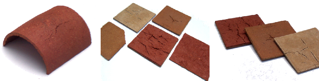
FIGURA 139. Probetas tierra aglomerada. Flexibilidad en la mezcla.
