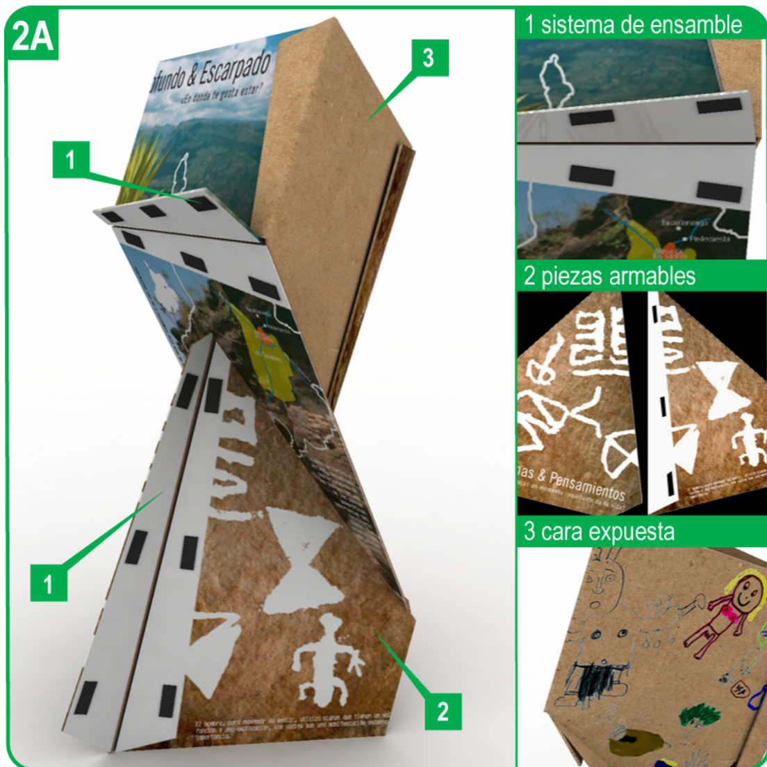
FIGURA 108. Descripción general modulo armable
