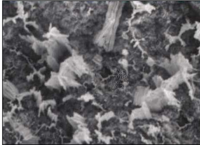
Figura 5. Corrosión por Picadura.
