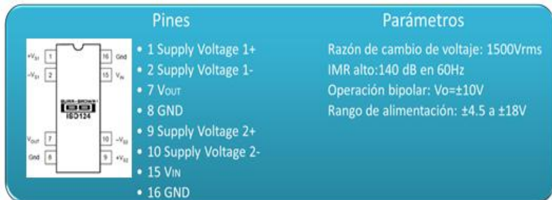
Figura 27. Características Principales del circuito integrado ISO124.
