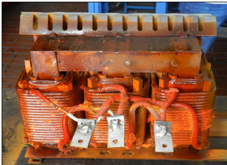
Figura B.2 Transformador trifásico cara frontal.
