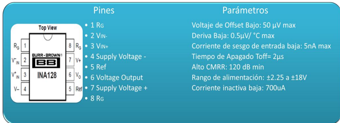
Figura 26. Características Principales del circuito integrado INA128.
