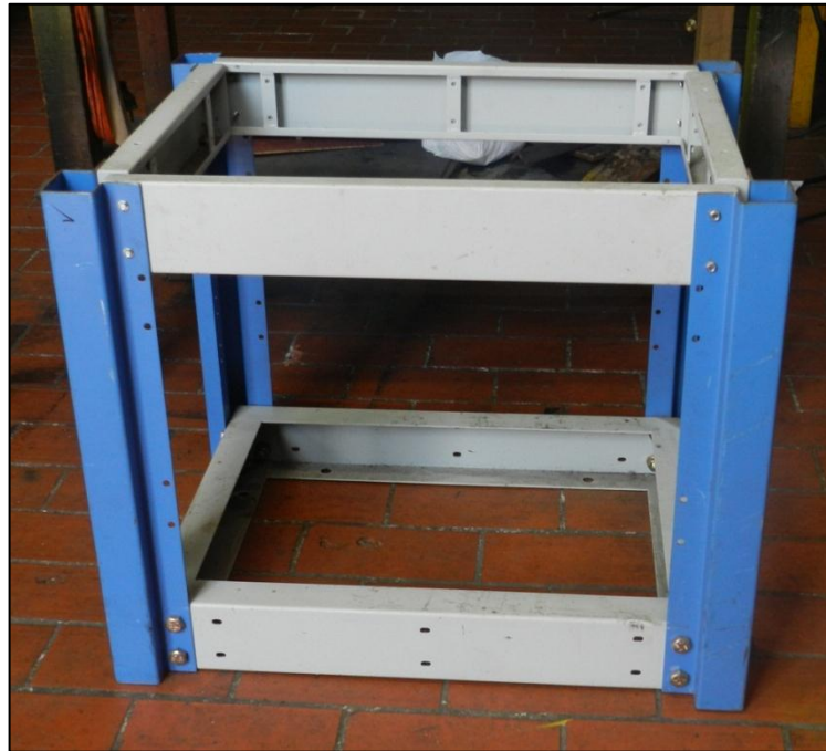
Figura B.3 Bases metálicas para el sistema de rectificación.
