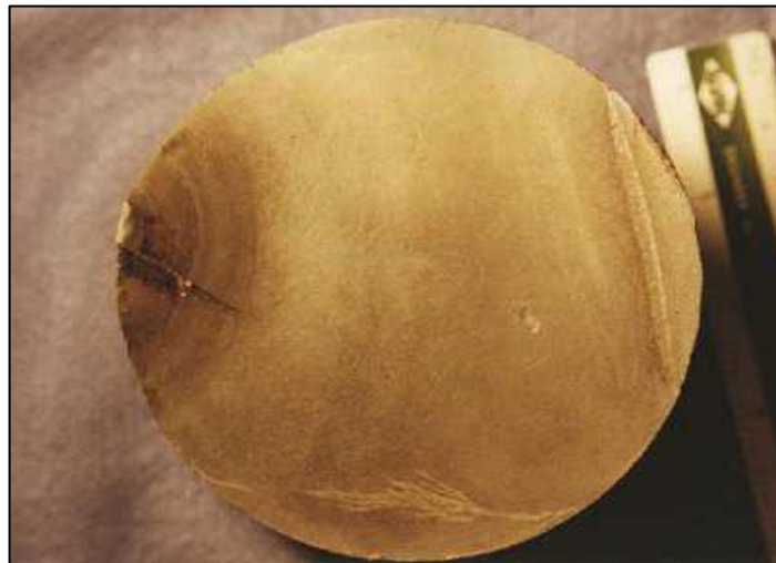
Figura 3. Corrosión por Erosión.
