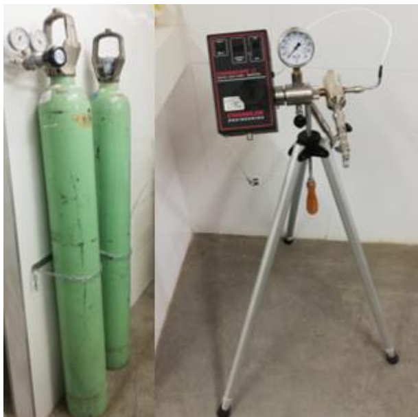
Figura 4. Distribución e instalación del higrómetro Chanscope II. Fuente: Autores
