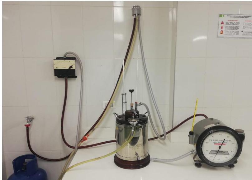
Figura 2. Distribución e instalación del CalorímetroP5615. Fuente: Autores
