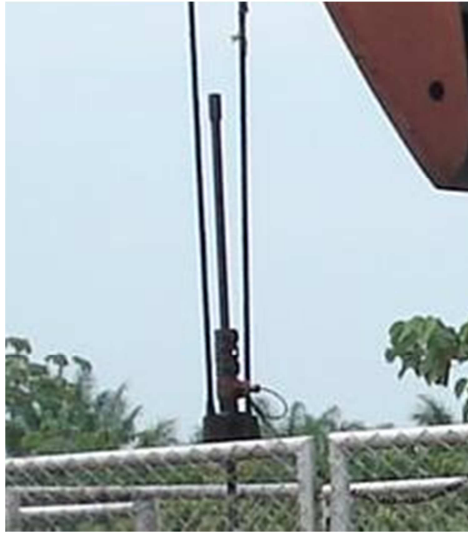
Figura 7. Típica instalación de una celda dinamométrica
