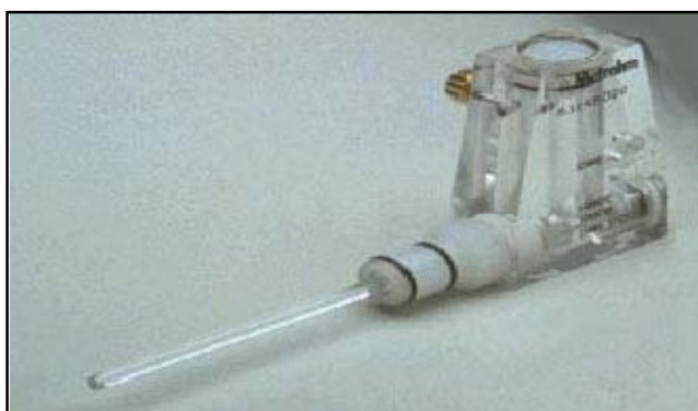
Figura 1. Imagen de un electrodo de mercurio; electrodo de trabajo para determinar cianuro libre 16
