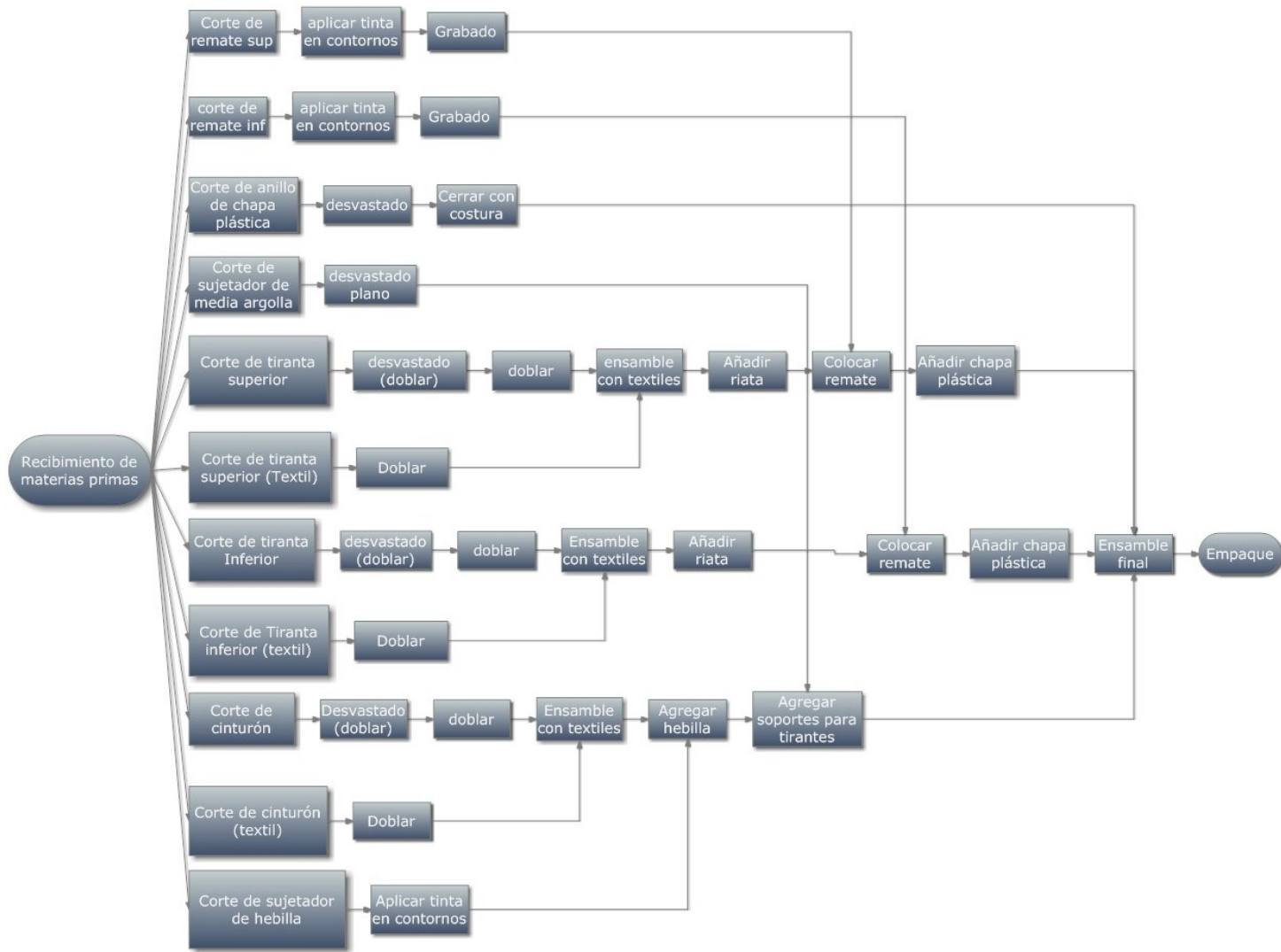
Figura 75. Diagrama de fabricación de arnés de tirantas
