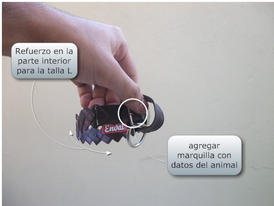
Fotografía 47. Mejoras y Correcciones Prototipo Collar Troquelado
