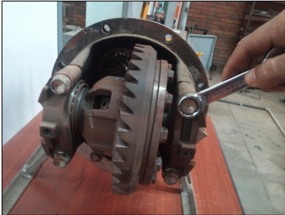
Figura 24. Apriete de bancadas
