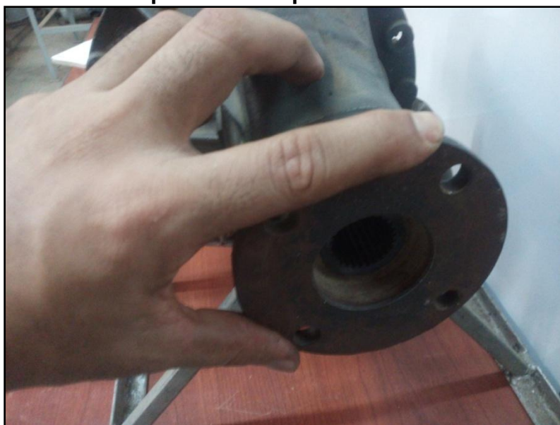
Figura 17 Extracción del piñón de ataque
