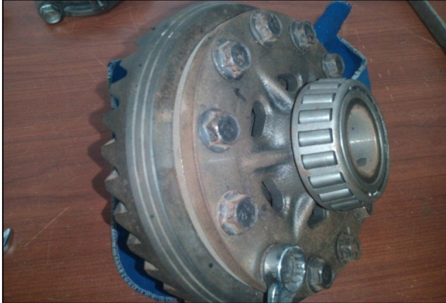
Figura 8. Desmontaje tornillos de la corona
