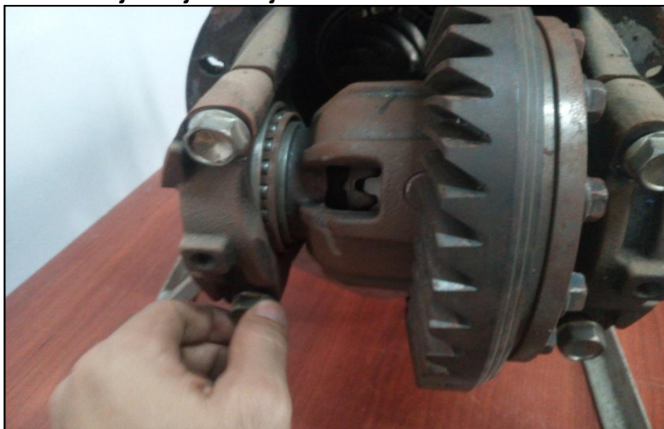
Figura 23. Montaje conjunto caja diferencial
