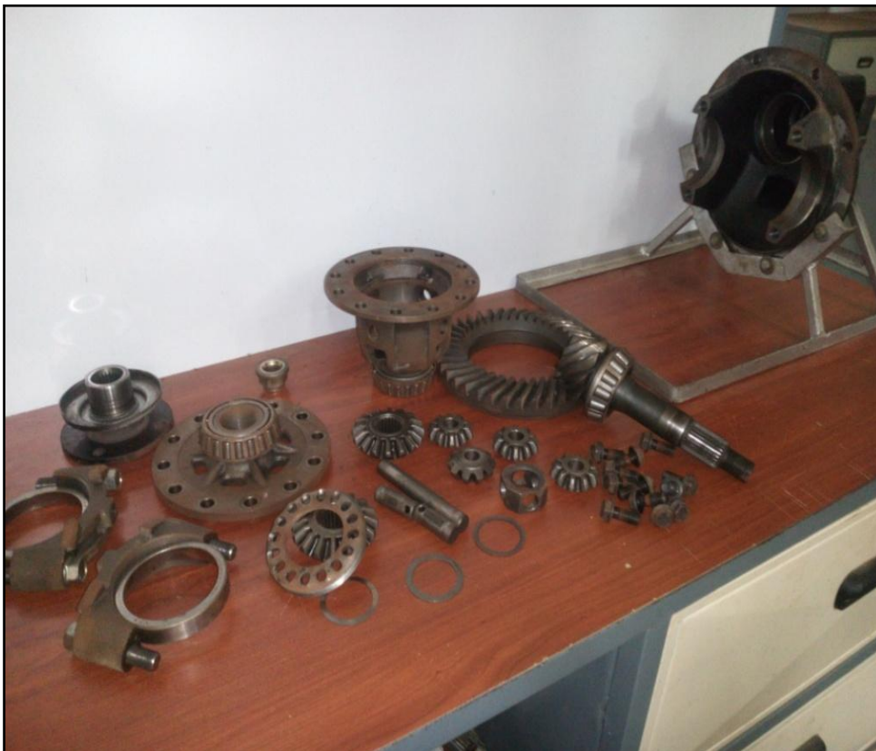
Figura 86 Foto registro desmontaje del diferencial
