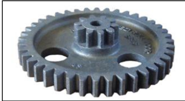
Figura 1 Engranaje obtenido por el proceso de fundición
