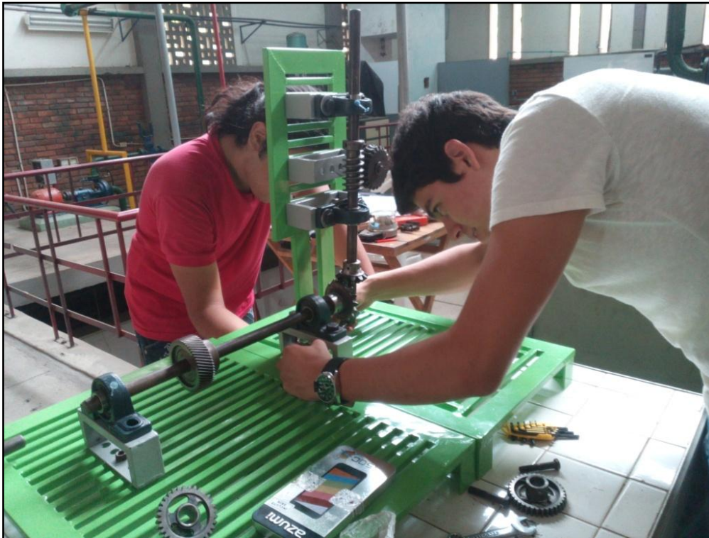
Figura 89 Foto registro Armado del mecano
