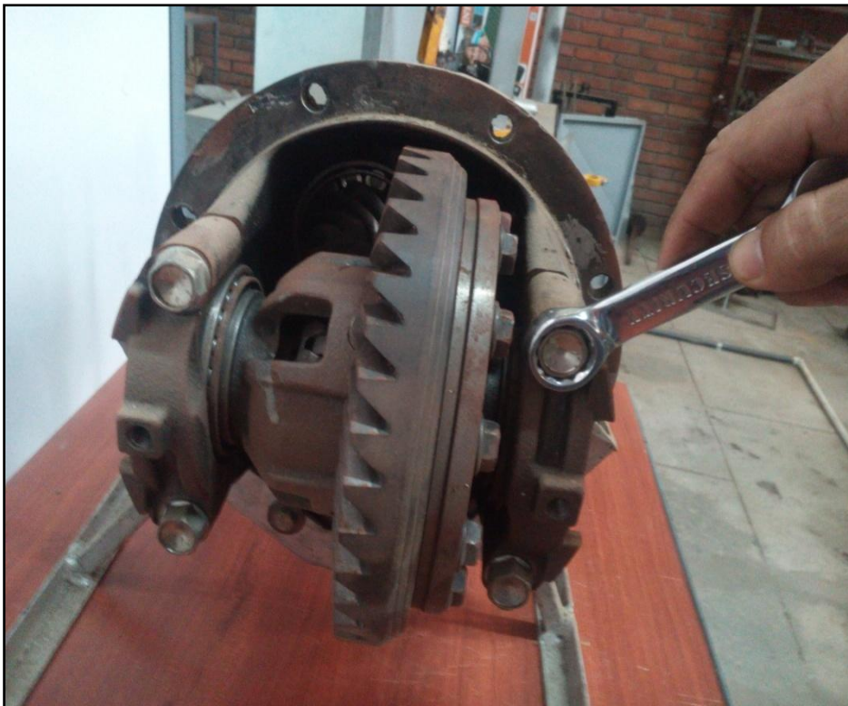
Figura 5. Remoción tornillos de la bancada
