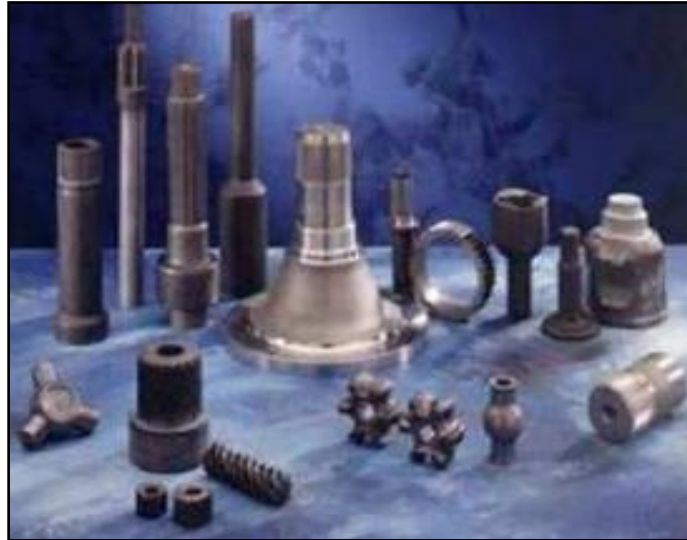
Figura 5 Piezas obtenidas por el proceso de extrusión
