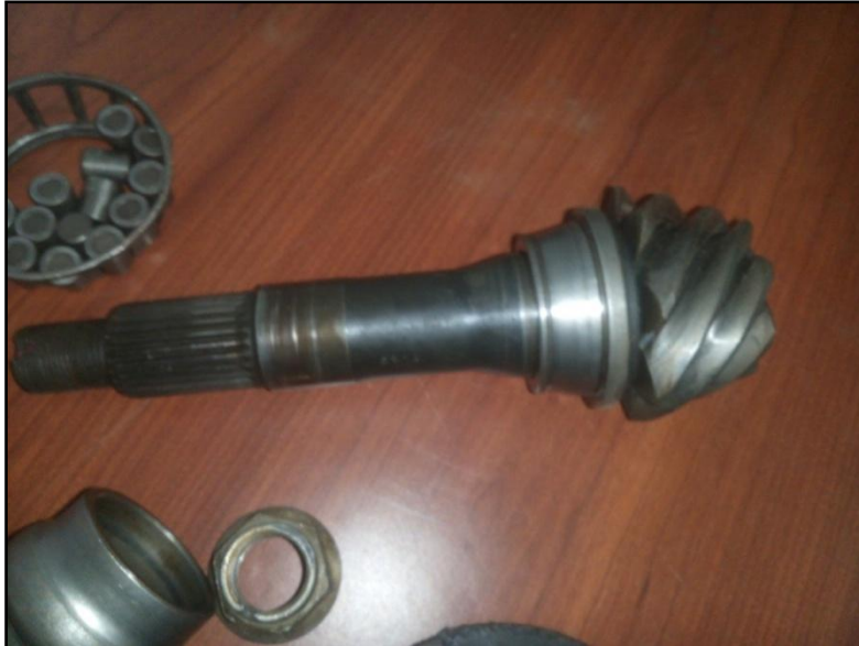
Figura 18. Desmontaje piñón de ataque
