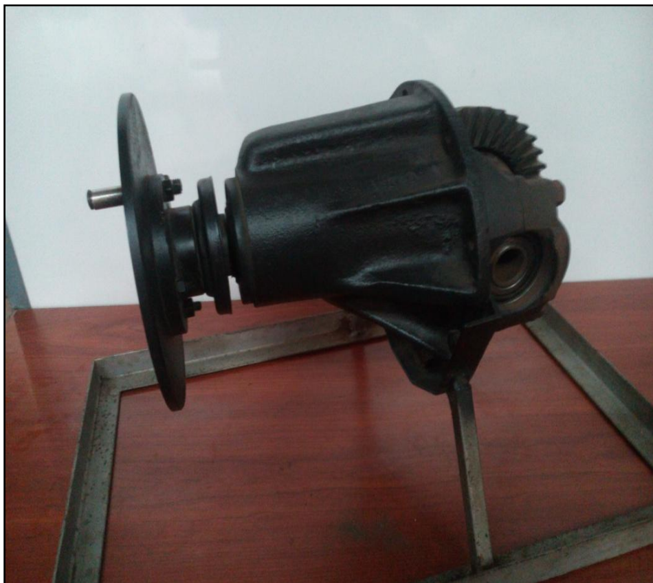
Figura 88 Foto registro del diferencial
