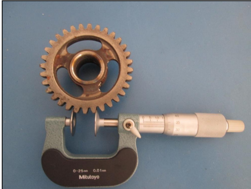
Figura 21. Medición micrómetro de platillos
