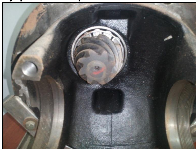
Figura 19. Montaje piñón de ataque
