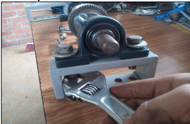
Figura 21. Desmontaje de bases de Chumaceras
