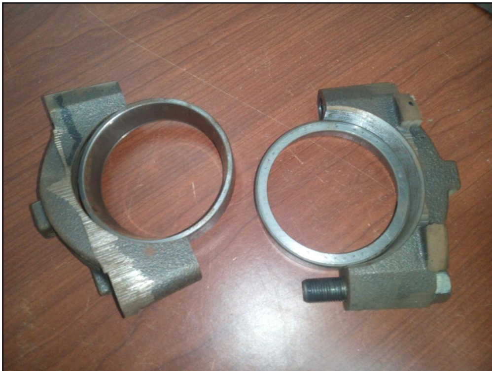
Figura 6.Desmontaje de las bancadas
