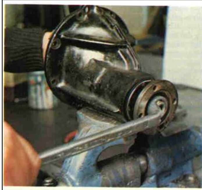
Figura 16 Desmontaje piñón de ataque
