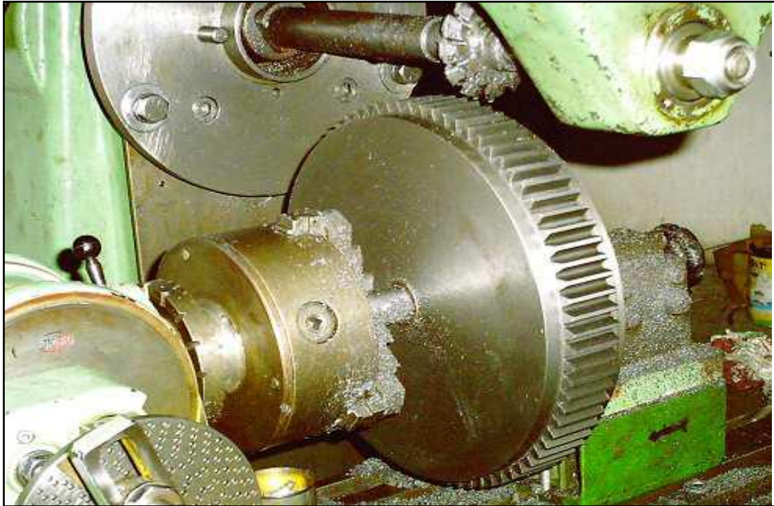
Figura 18 Fresado de un engranaje Recto
