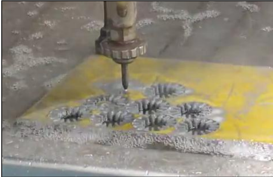
Figura 23 Corte por chorro de agua de un engranaje
