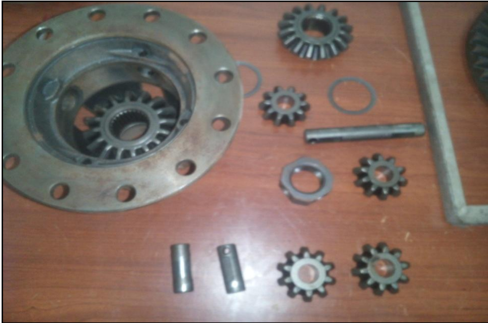
Figura 20 Montaje Caja diferencial
