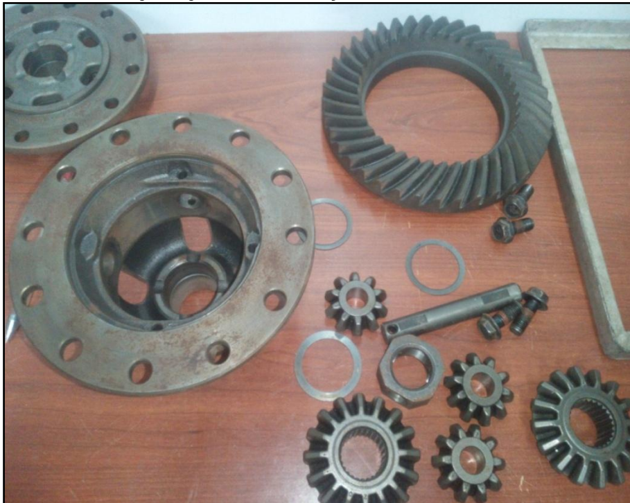
Figura 15 Desmontaje caja diferencial y corona
