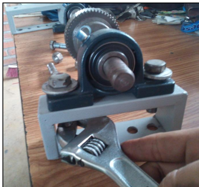
Figura 18. Fijación de Chumaceras a su Base
