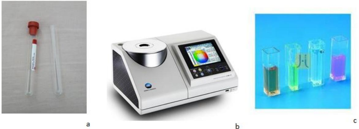
(a) Tubos de Kahn, (b) Espectrofotómetro, (c) Cubetas espectrofotométricas de caras paralelas.
