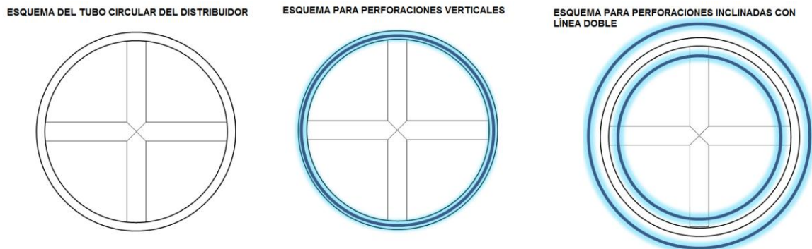
Figura 26. Esquemas de aspersión del vapor para el tubo circular de acuerdo con la disposición de los orificios
