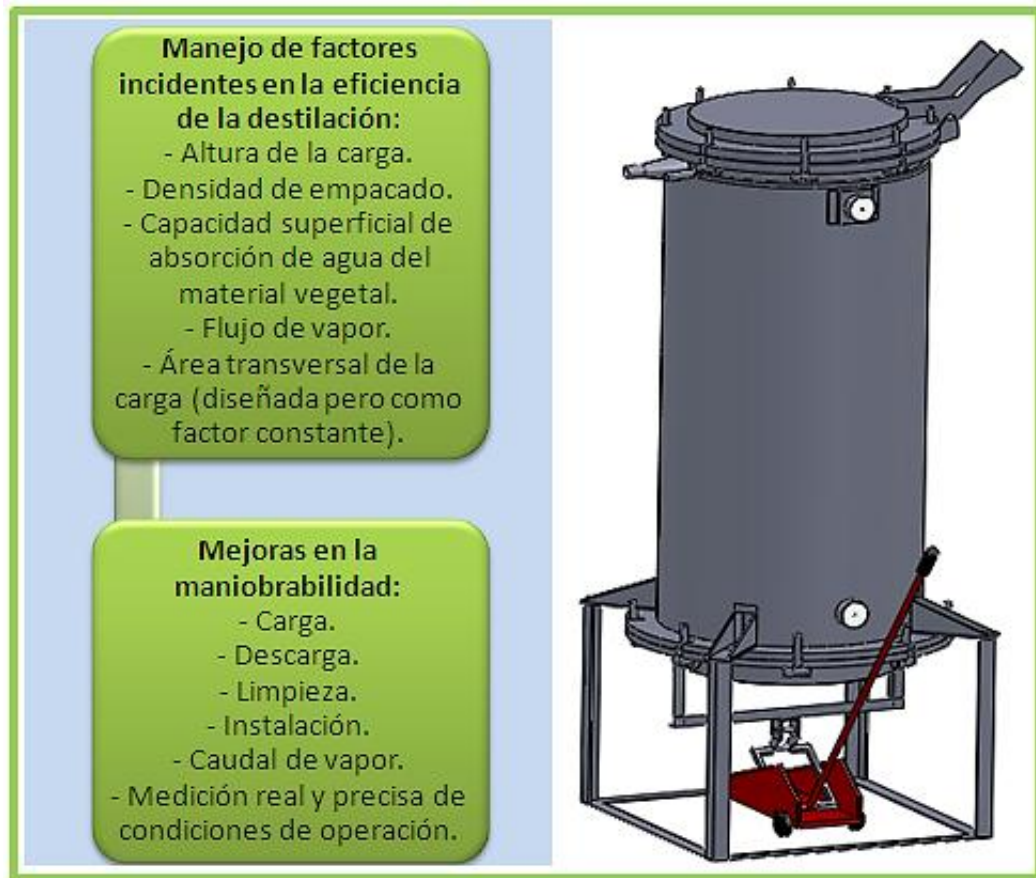
Figura 14. Esquema diseño final
