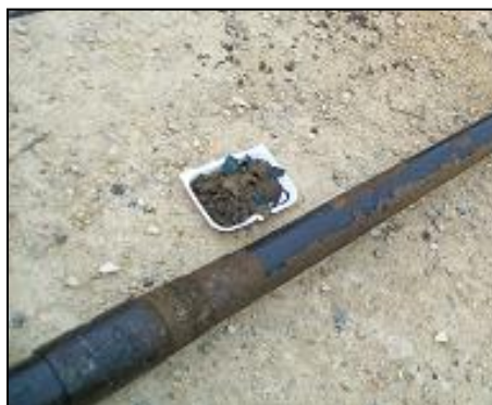
Figura 67. Depósitos inorgánicos de fondo de pozo. GUA-149.
