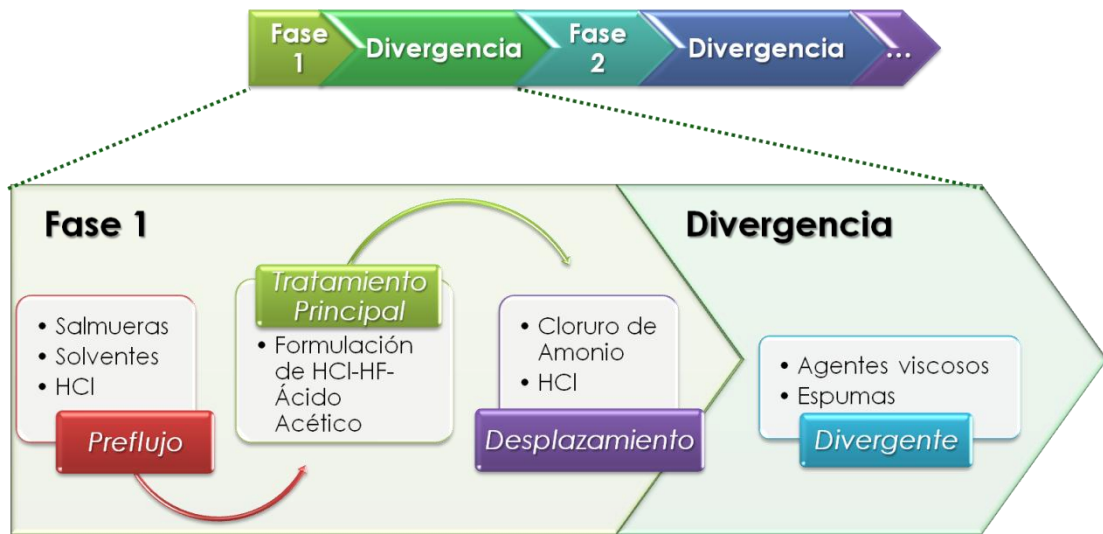
Figura 40. Secuencia Típica de Una Estimulación Ácida
