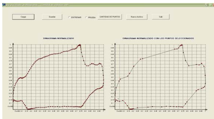
Figura 73. Análisis del Pre-procesador, Ala izquierda dinagrama normalizado, a la derecha dinagrama elaborado con los 60 puntos significativos.
