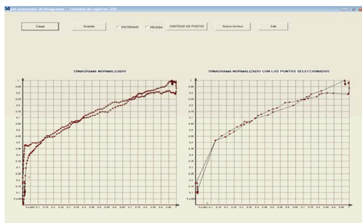
Figura 79. Análisis del Pre-procesador, Ala izquierda dinagrama normalizado, a la derecha dinagrama elaborado con los 60 puntos significativos.
