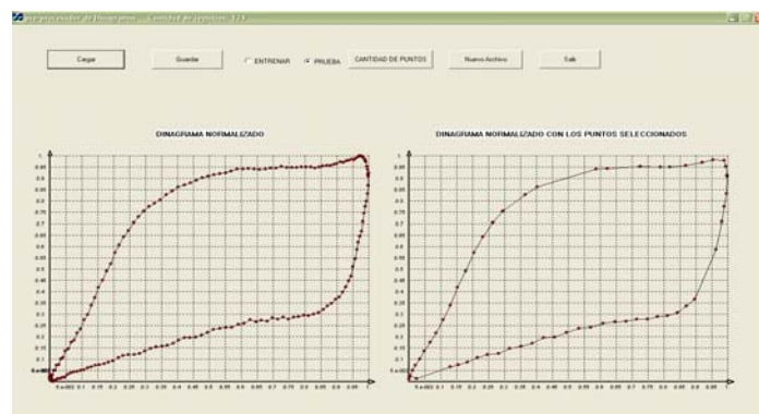
Figura 70. Análisis del Pre-procesador, Ala izquierda dinagrama normalizado, a la derecha dinagrama elaborado con los 60 puntos significativos.
