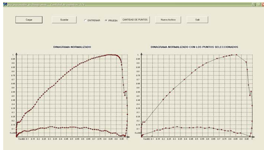
Figura 68. Análisis del Pre-procesador, Ala izquierda dinagrama normalizado, a la derecha dinagrama elaborado con los 60 puntos significativos.
