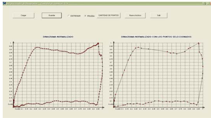
Figura 69. Análisis del Pre-procesador, Ala izquierda dinagrama normalizado, a la derecha dinagrama elaborado con los 60 puntos significativos.
