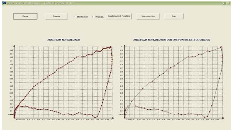
Figura 72. Análisis del Pre-procesador, Ala izquierda dinagrama normalizado, a la derecha dinagrama elaborado con los 60 puntos significativos.
