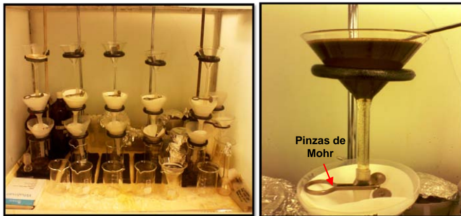
Figura 7. Montaje de centrifugado para la separación de los minerales pesados con yoduro de metileno.
